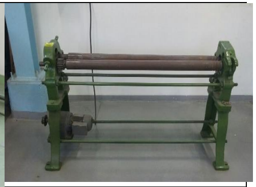
Estado final de la Roladora una vez aplicado el proceso de reparación
