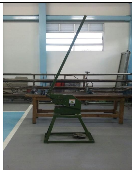
Estado final de la Guillotina una vez aplicados los procesos anteriores
