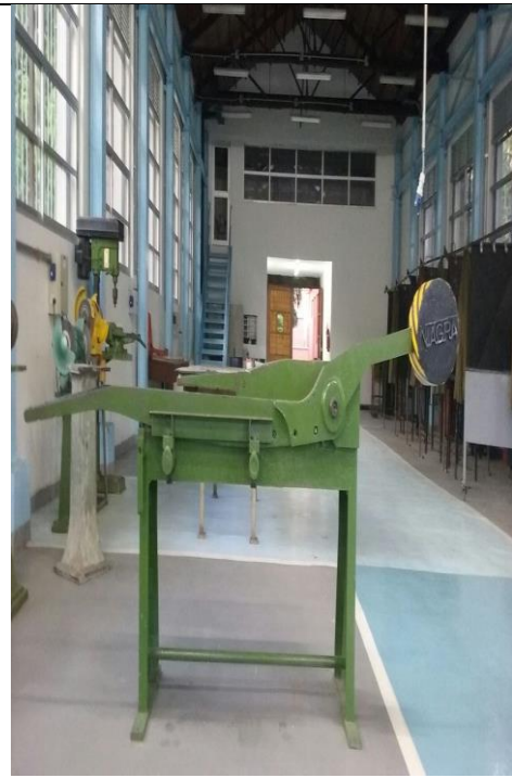
Estado final de la Cizalla una vez aplicado el proceso de reparación
