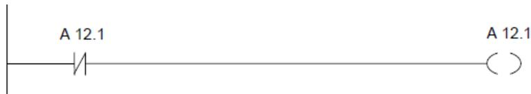
**Figura 35. Esquema de contacto segmento 2 para activar las lámparas del panel indicador**
