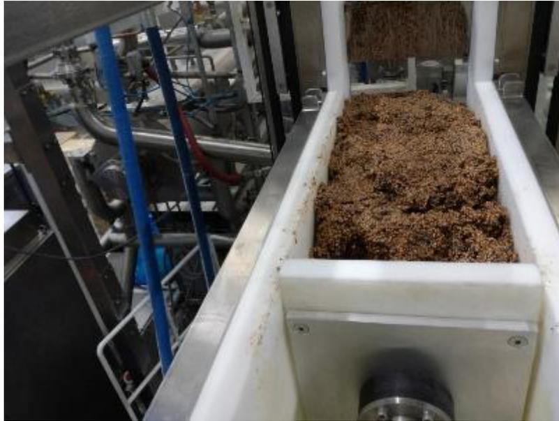
**Figura 56.** Sistema de empuje de masa de fruta llevando el producto hacia la guillotina para ser cortado, se observa el buen funcionamiento del tornillo y que el producto no se está quedando adherido a las paredes del cajón.
