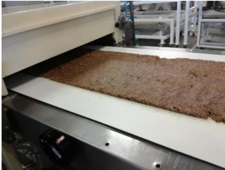
**Figura 58.** Tela formada después de pasar por los rodillos, entrando a túnel de enfriamiento.
