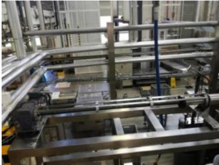
**Figura 48.** Imagen real de dosificadora y cortadora de masa de fruta instalada. Fuente CNCH.
