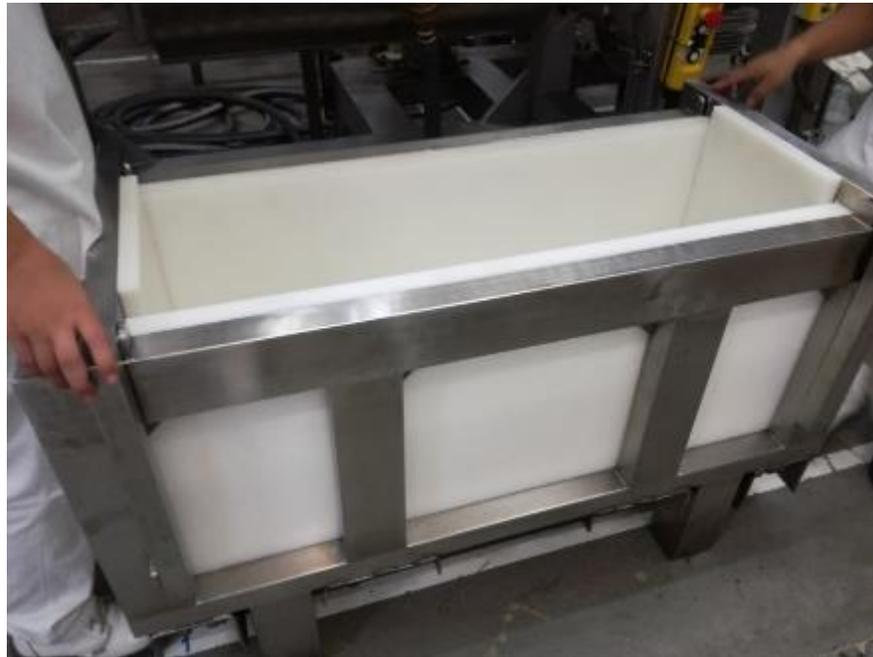
**Figura 52.** Cajón en estructura inoxidable y con recubrimiento en teflón para evitar que el producto se quede pegado en las paredes. Con capacidad para 100 kg de producto. Fuente CNCH.
