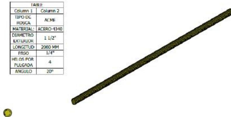
**Figura 19.** Isométrico del tornillo sinfín en INVENTOR. Fuente propia
