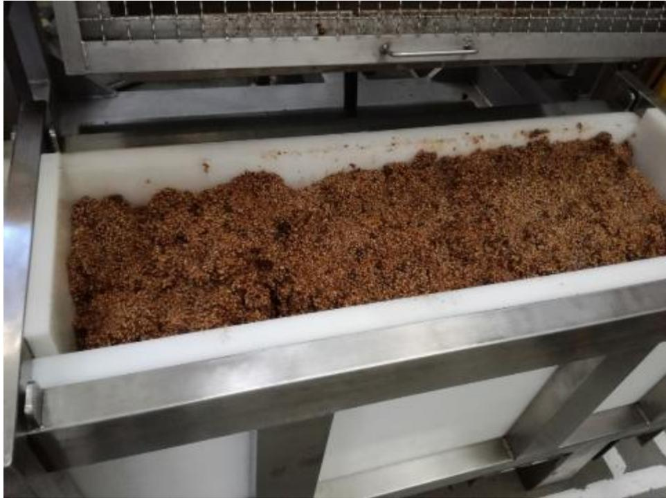
**Figura 54.** Producto depositado en el cajón para luego llevarlo hacia la dosificadora y cortadora de masa de fruta (capacidad 100kg). Fuente CNCH.
