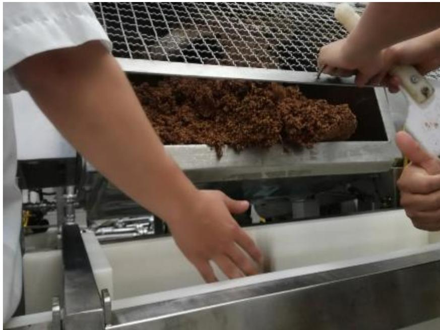
**Figura 53.** Mezclado de la masa de fruta, para luego depositarlo en el cajón. Fuente CNCH.
