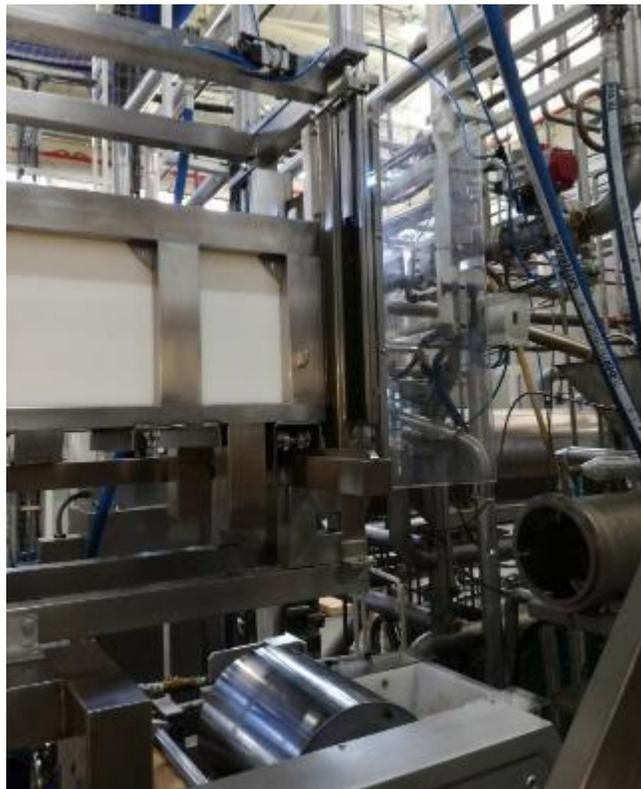
**Figura 59.** Tolva y rodillos formadores. Fuente CNCH.
