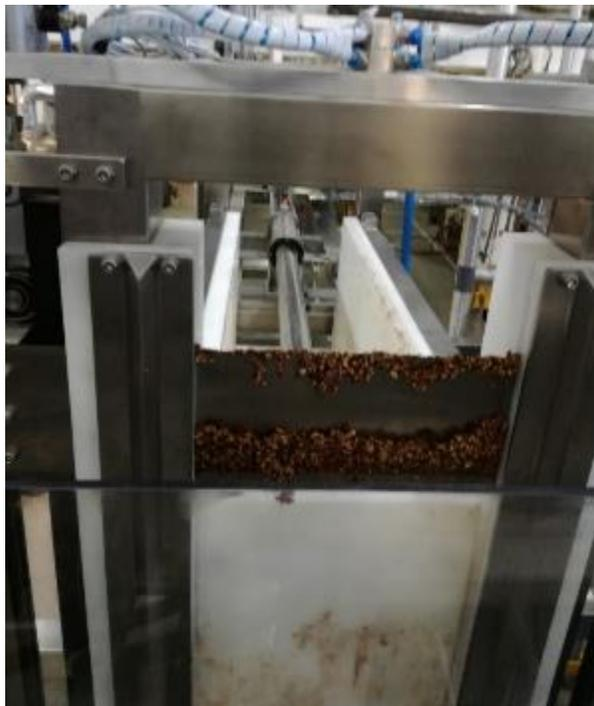
**Figura 61.** Dosificador y guillotina terminando el ciclo de dosificado y corte, se observa un buen desempeño de ambos mecanismos como se puede apreciar en la foto. Fuente CNCH.
