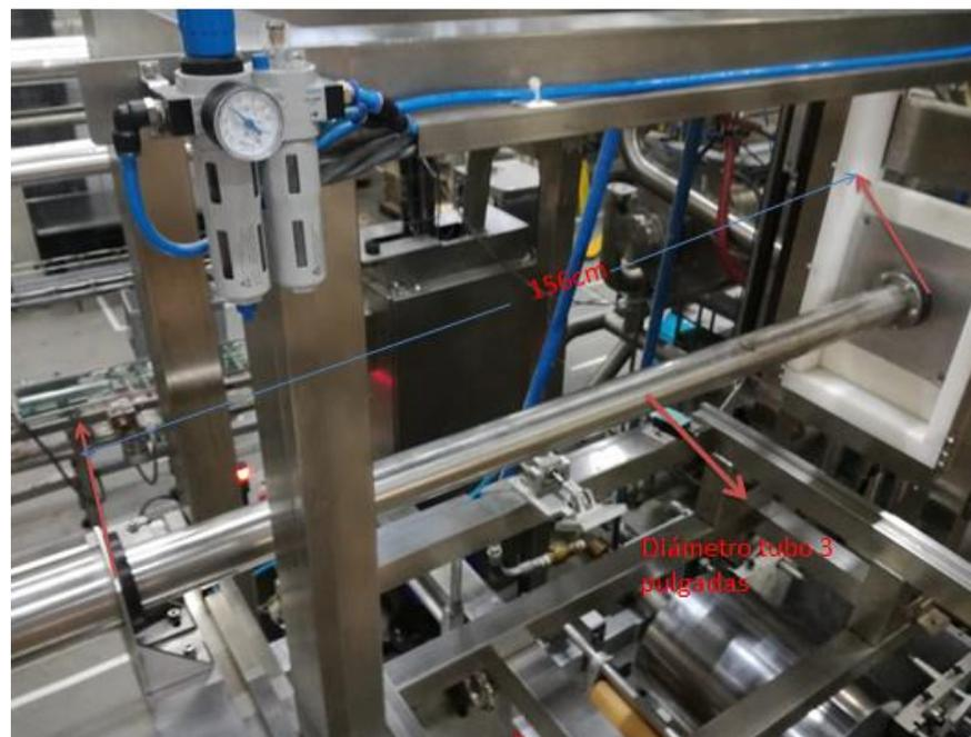
**Figura 44.** Imagen real Soporte de 4 pulgadas de diámetro concéntrico con el tubo de 3 pulgadas. Fuente propia
