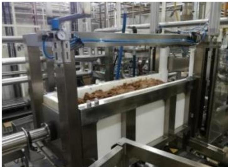
**Figura 49.** Imagen real de dosificadora y cortadora de masa de fruta. Fuente CNCH
