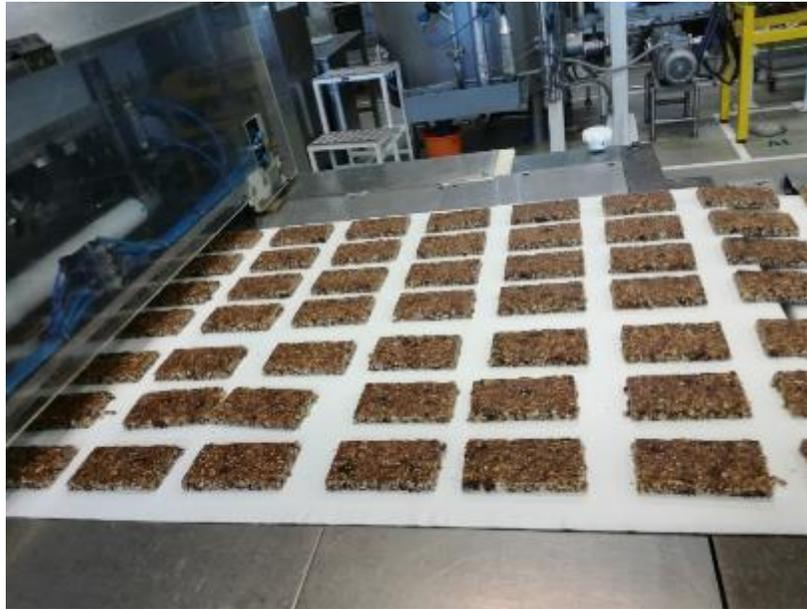
**Figura 60.** Producto cortado longitudinal y transversal para luego ser empacado. Fuente CNCH.
