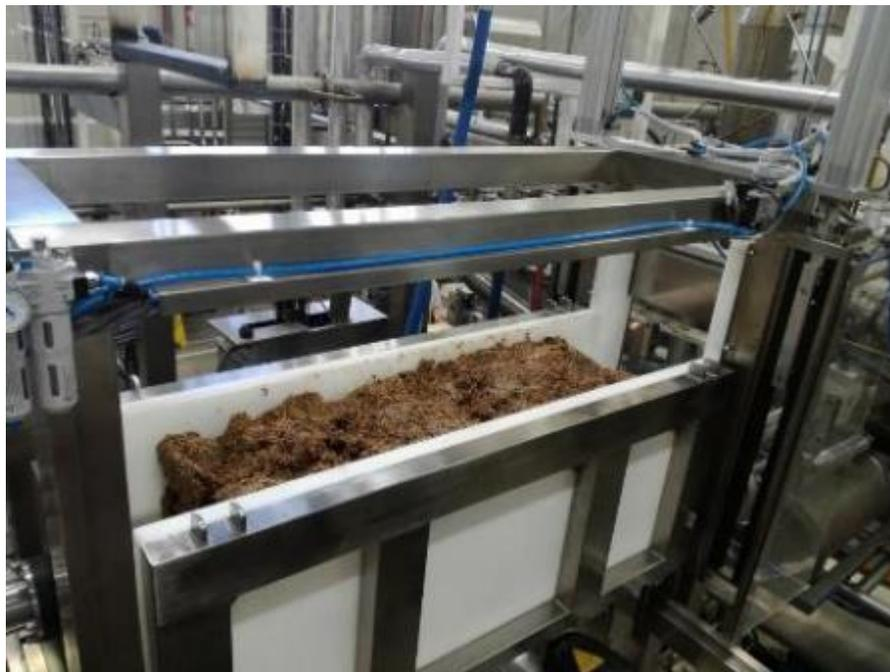
**Figura 55.** Cajón con producto instalado sobre la estructura secundaria para empezar con el proceso de dosificado y corte. Fuente CNCH.
