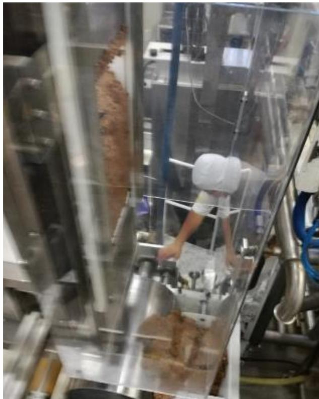
**Figura 57.** Guillotina neumática cortando el producto y siendo dosificado a los rodillos formadores para luego moldear la tela. Fuente CNCH.
