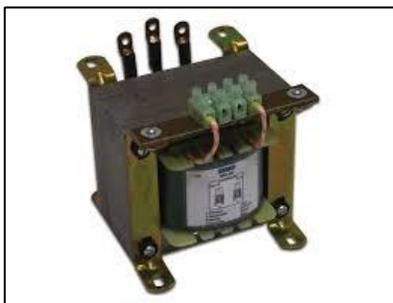
Figura 19. Transformador de tensión de 400 a 110 voltios de 50 VA. Tomado del propio proyecto.
