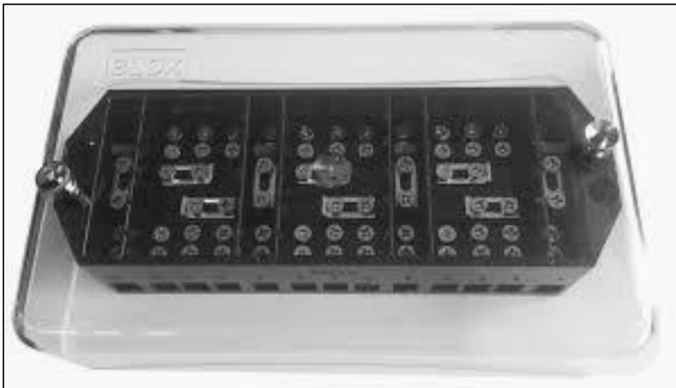
Figura 16. Bornera de prueba. Tomado del propio proyecto.
