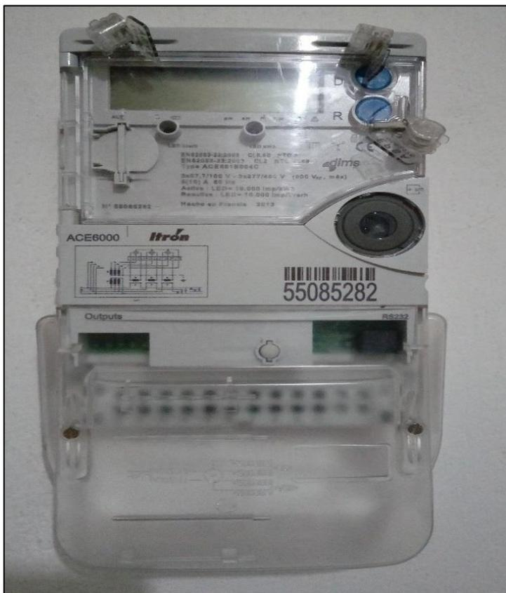
Figura 15. Medidor ACE6000. Tomado del propio proyecto.
