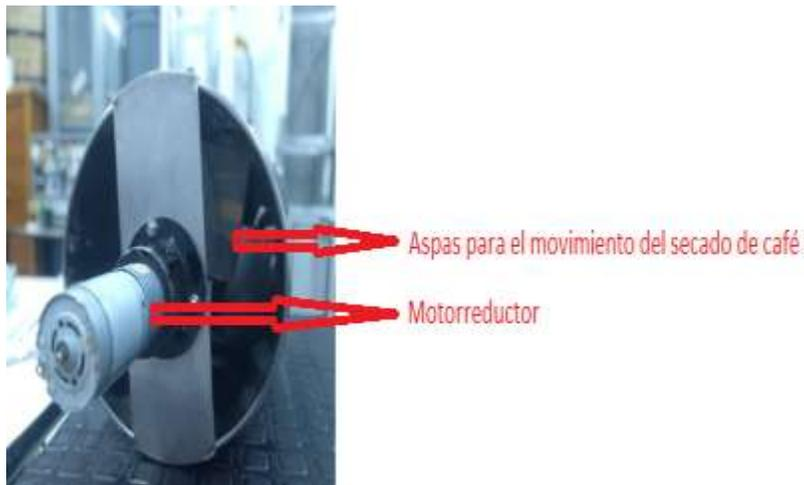
Figura 23. Sistema automatizado de la máquina de café.
