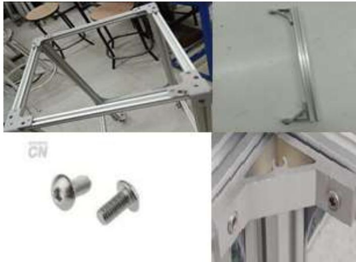
*Figura 17.* Elaboración de los cuadros para la estructura.
