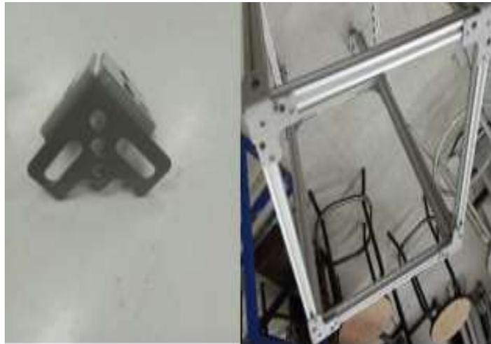
Figura 21. Instalación de esquinero superior.
