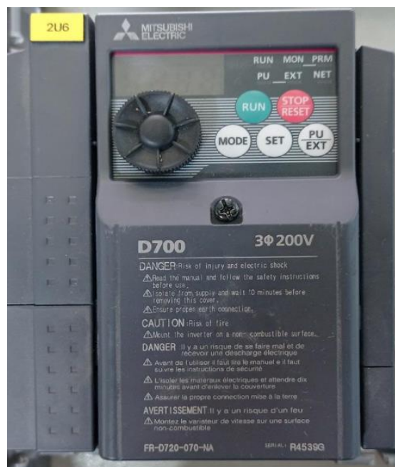
Figura 42. Variador de Velocidad D700 Mitsubishi Electric. Fuente Propia
