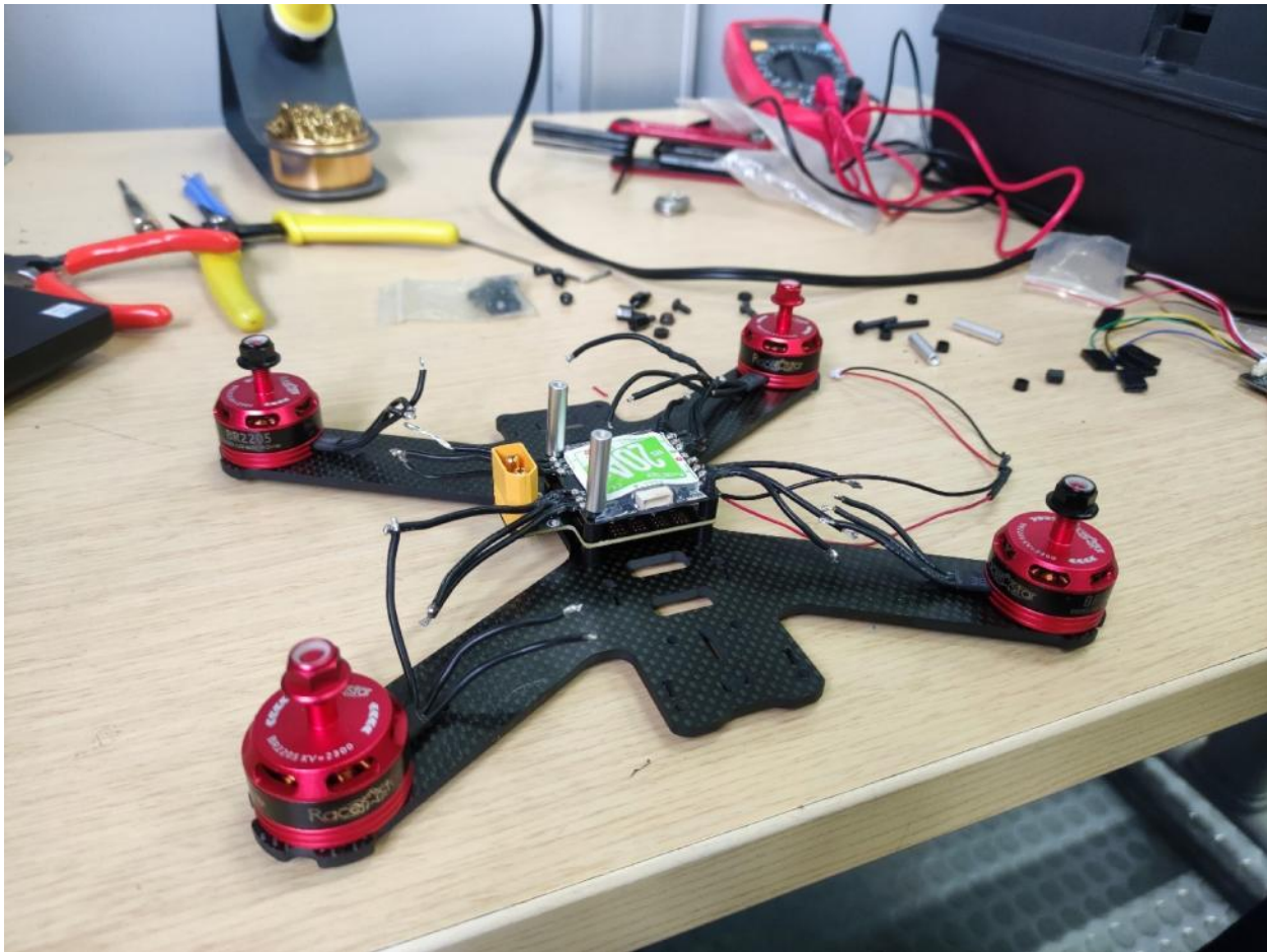
Figura 20 MONTAJE Y CONEXION DE PLACA DISTRIBUIDORA
