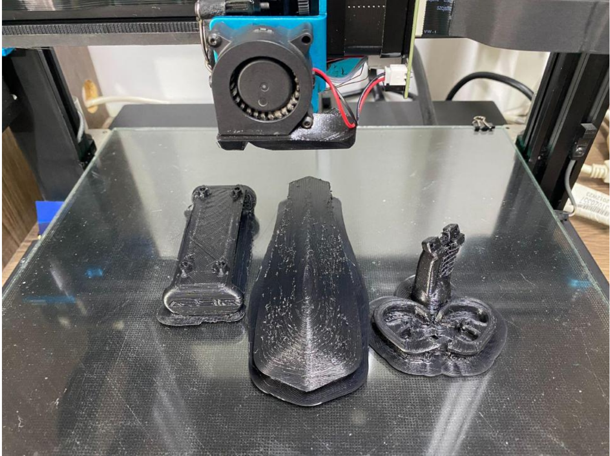
Figura 11 IMPRESION 3D DE FRAME Y PIEZAS DE DRONE
