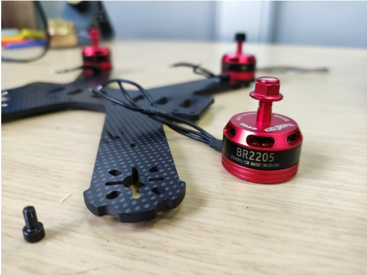
Figura 17 MONTAJE DE MOTORES SIN ESCOBILLAS EN EL FRAME X
