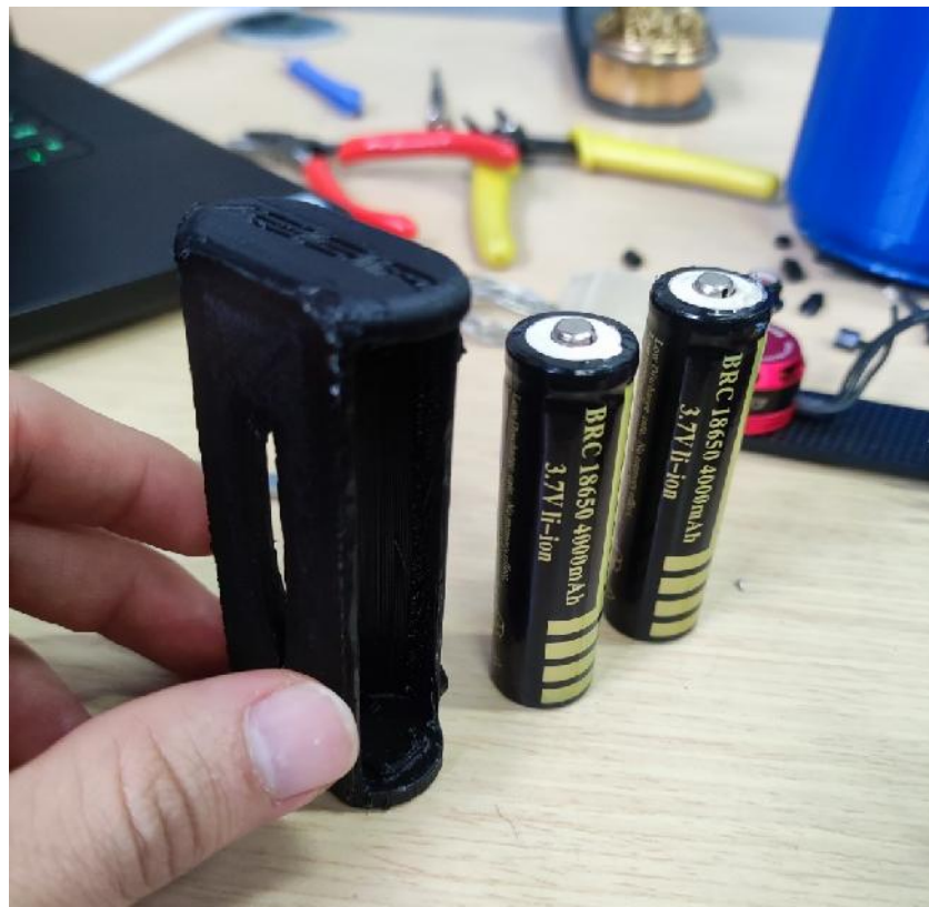
Figura 22 MONTAJE DE BATERIAS EN SOPORTE DE BATERIAS IMPRESO EN 3D
