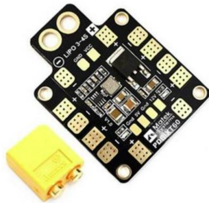
Figura 19 PLACA DISTRIBUIDORA DE ENERGIA - PDB
