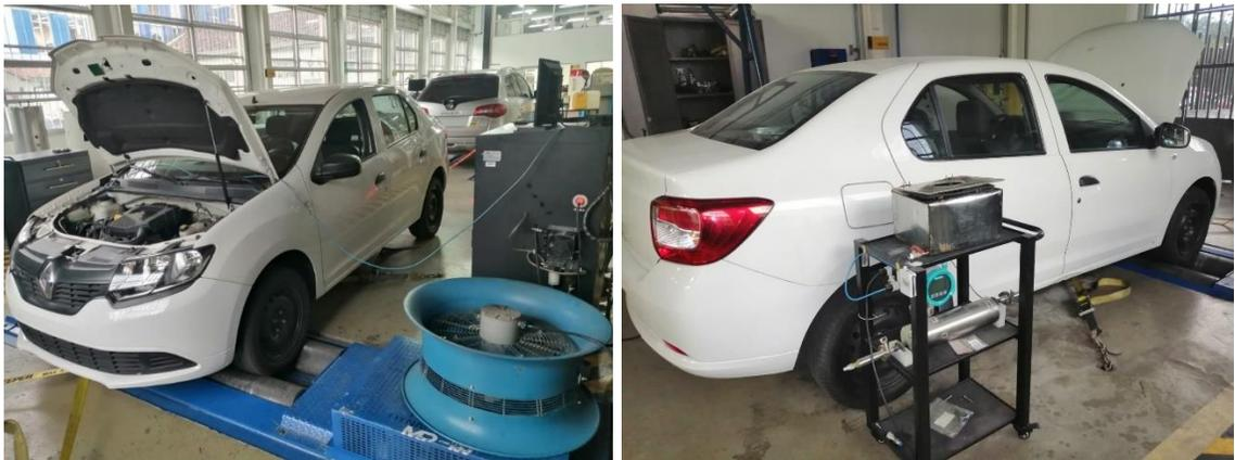
Figura 5. Vehículo en dinamómetro
