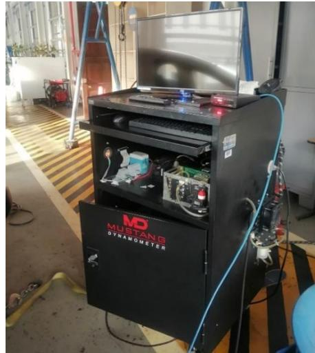
Figura 6. Equipo de control, visualización y almacenamiento de datos del dinamómetro.
