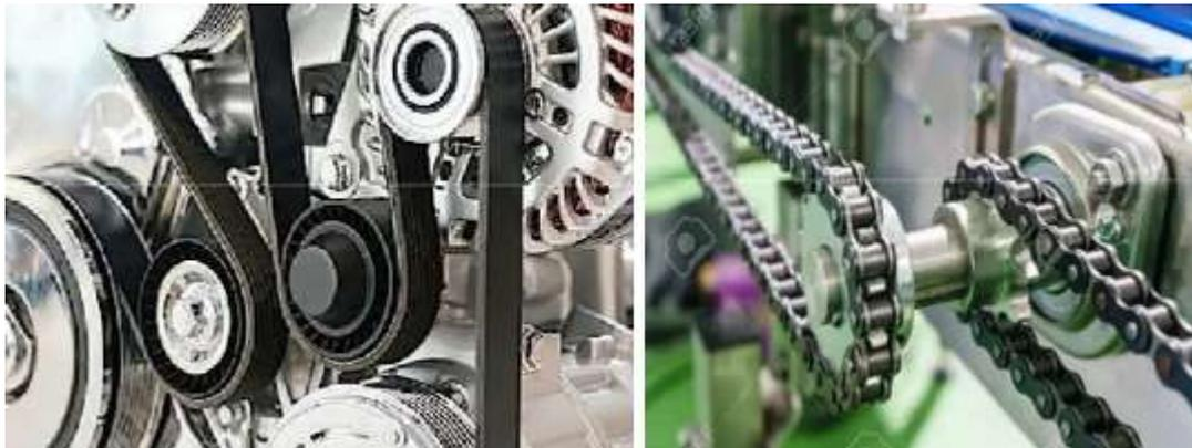
Figura 1. Sistemas de transmisión por correas y cadenas.
