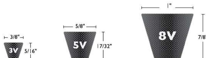
Figura 17. Geometría y dimensiones de correas en V.
