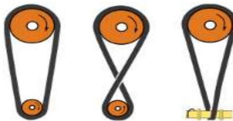
Figura 7. Formas de trabajo de las correas planas, redondas o doble V.
