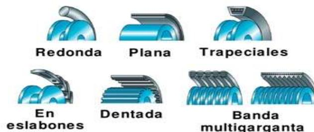
Figura 6. Tipo de correas mecánicas existentes.
