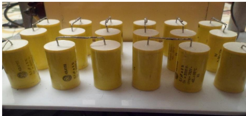
Fig.9 Banco de condensadores
