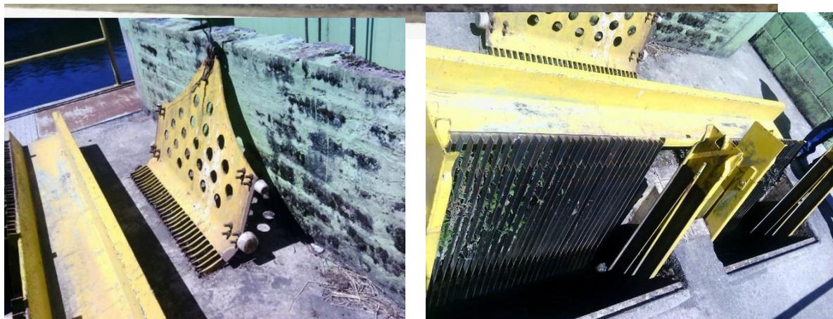
Fotografía 2. Cepillo electromecánico en desuso para limpiar las rejas filtradoras, Tomada por Jaime Espinal
