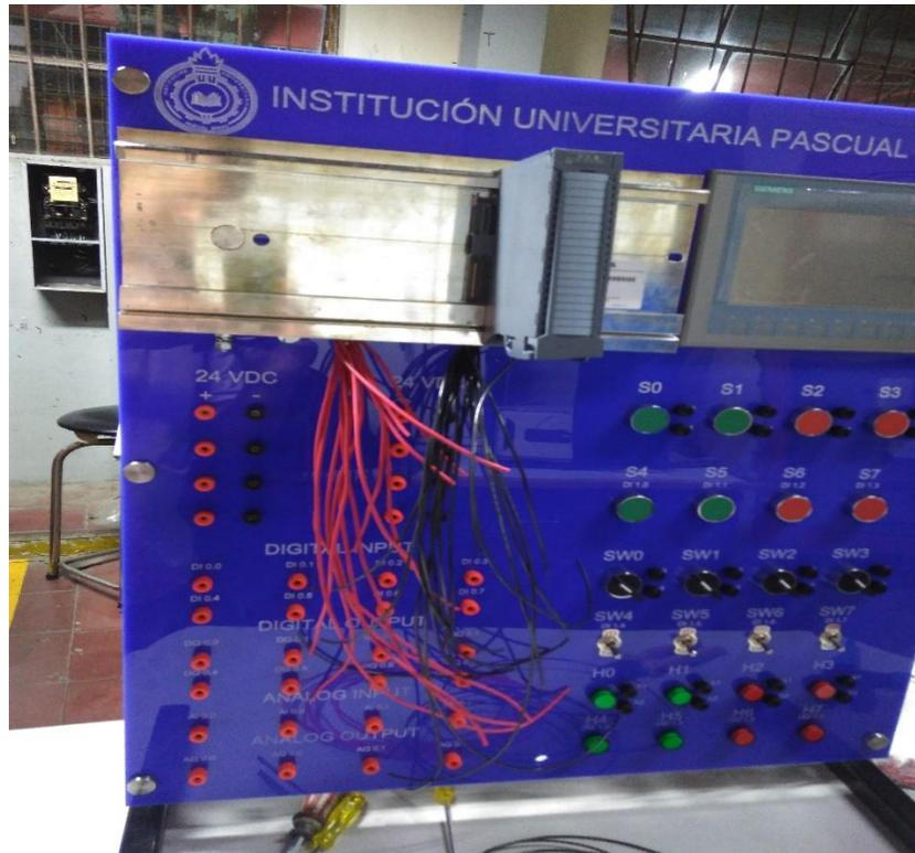
**Figura52.** *Ensamble del Módulo S7-1500 parte frontal*
