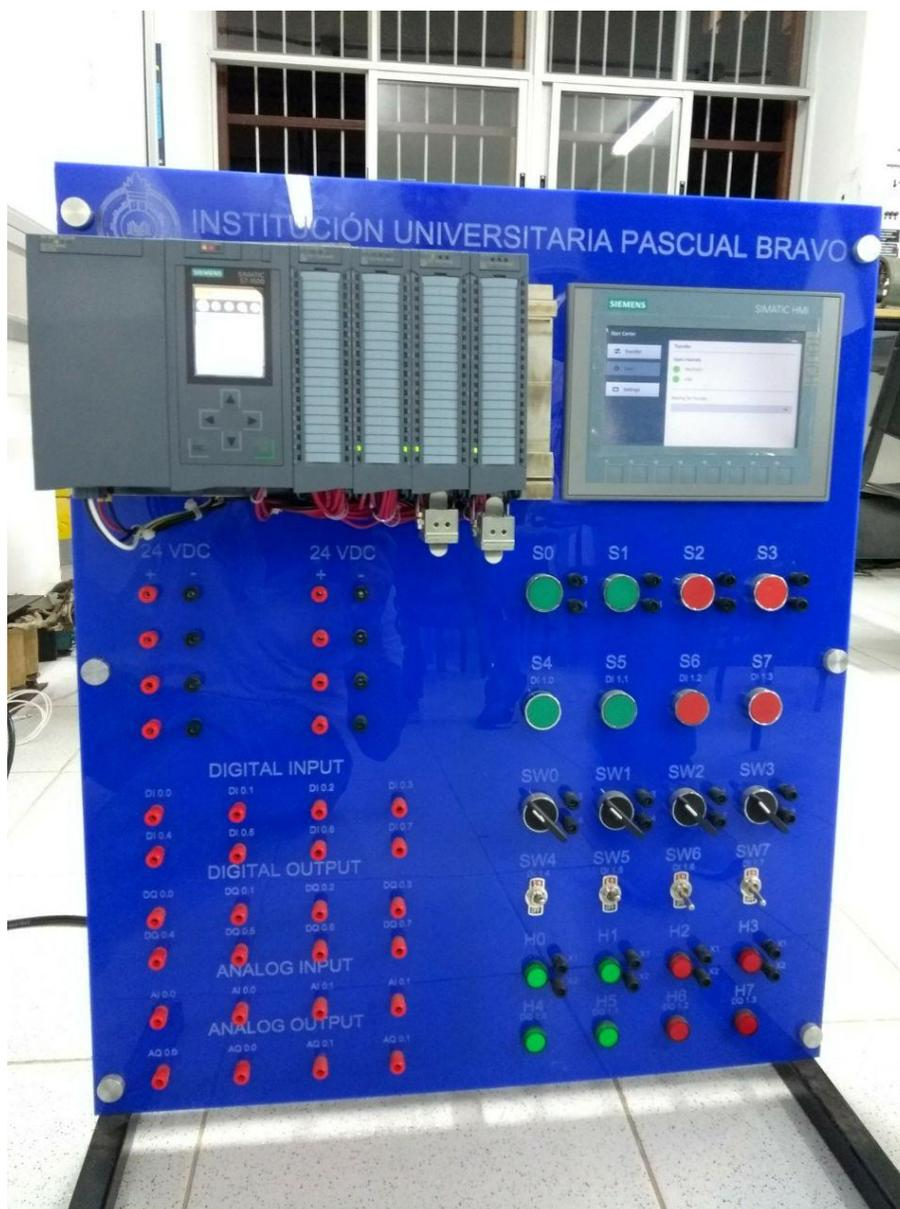
**Figura 534.** Módulo S7-1500 terminado parte frontal.
