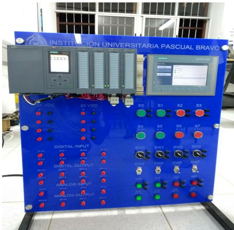
*Figura 55. Prueba de funcionamiento Módulo PLC S7-1500.*
