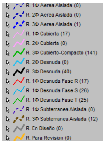
Figura 3. Convenciones para tipo de cableado
