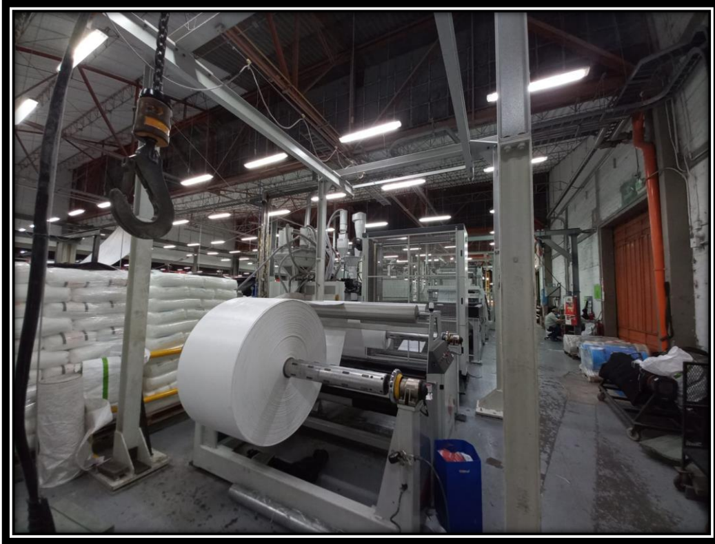
Figura 18. Bobinado del rollo en la máquina laminadora
