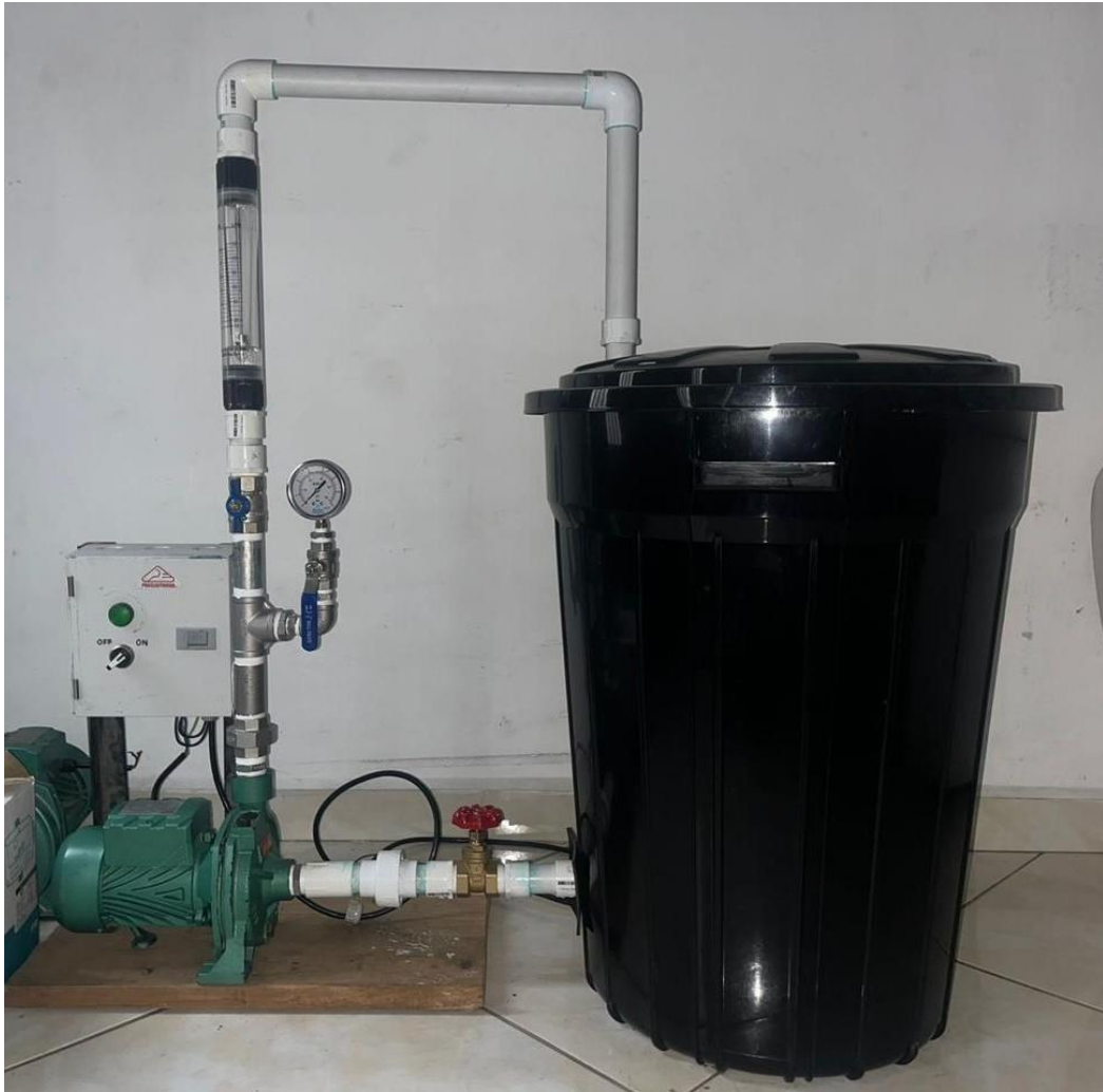
Figura 57 Banco de pruebas para electrobombas de bajas potencias 1/4hp a 1hp Fuente: Elaboración propia
