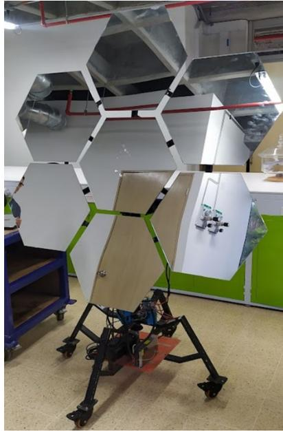
Figura 2. Heliostato disponible para el proyecto
