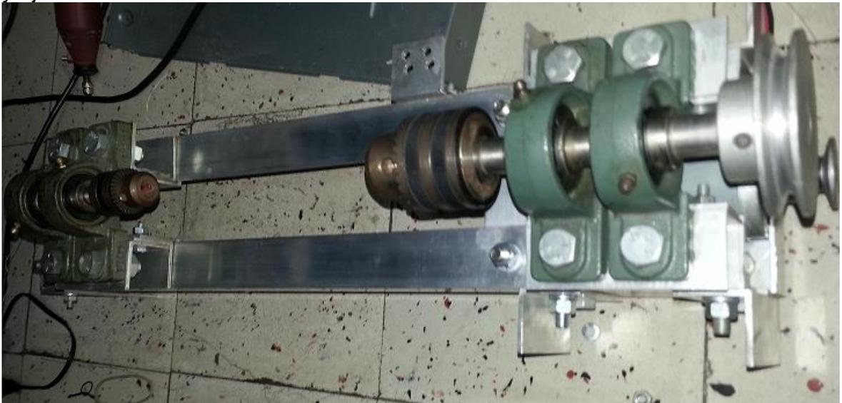
**ANEXO E.** Motor paso a paso con acople para tornillo.
