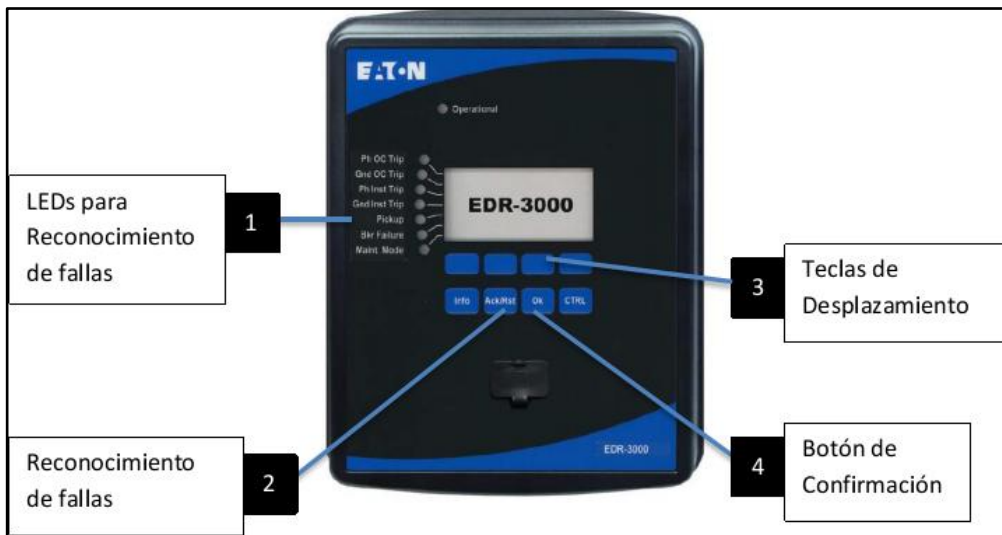
Figura 23: EDR-3000 - Elementos de Monitoreo y Reconocimiento de Fallas. [01]
