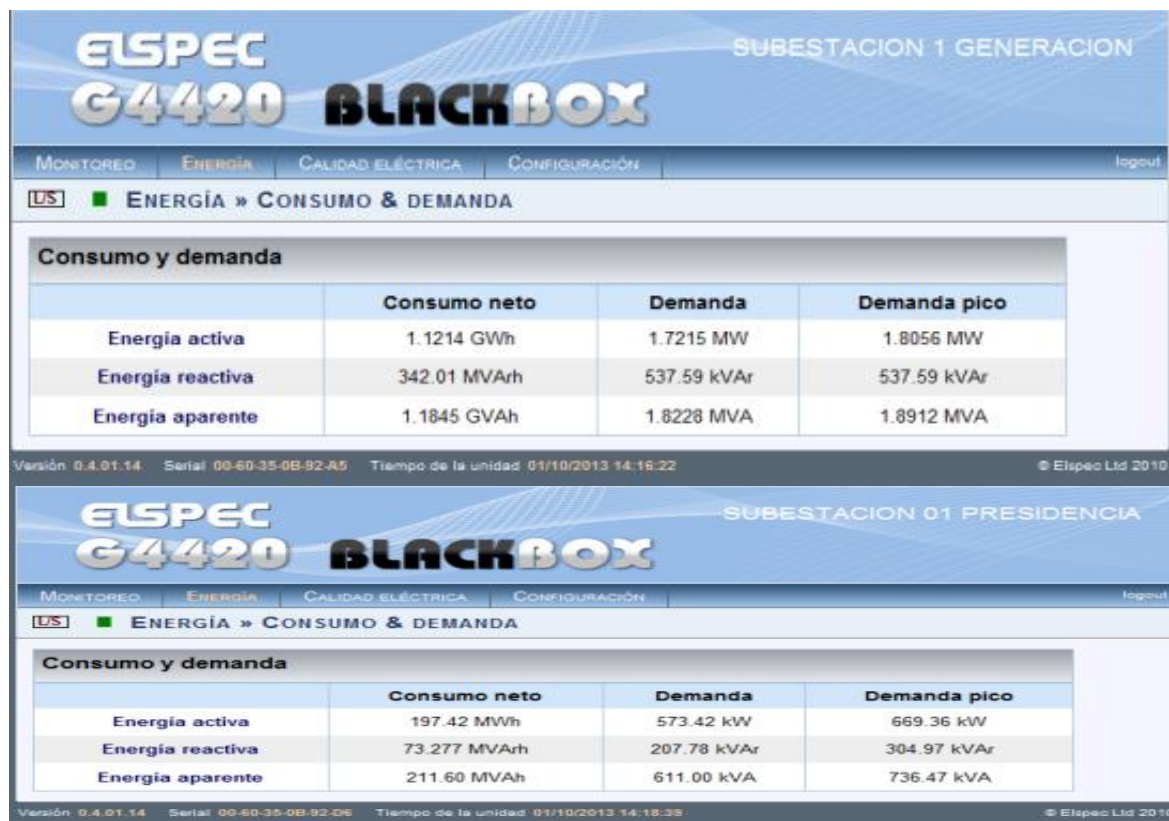
Figura 3: Demanda y consumo de energía en la subestación principal. [01]
