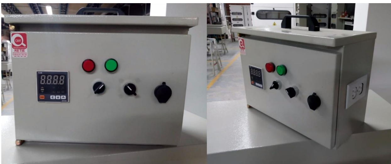
Anexo 2. Tablero control de temperatura Fuente: diseño propio
