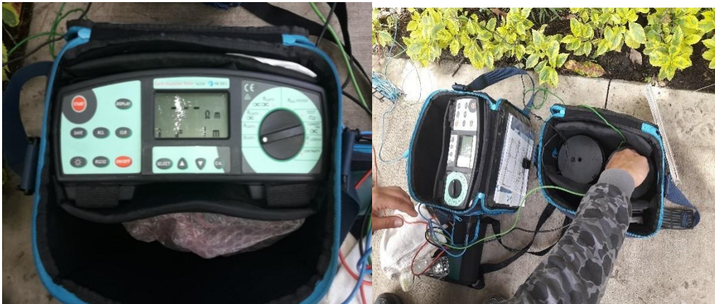
Figura 34. Telurómetro METREL MI2088. Fuente: diseño Jairo Alberto Barbosa Barrera
