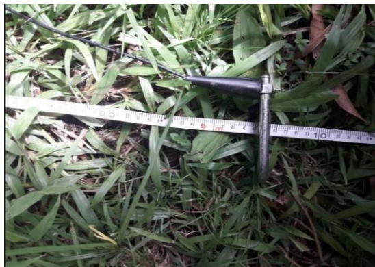
Figura 47. Resultado medidas de resistividad del suelo con longitudes de 0,2,4 y 6 metros Fuente: diseño Edwin Arbey Barbosa Barrera
