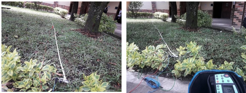
Figura 37. Método de medida Wenner. Fuente: diseño Jairo Alberto Barbosa Barrera
