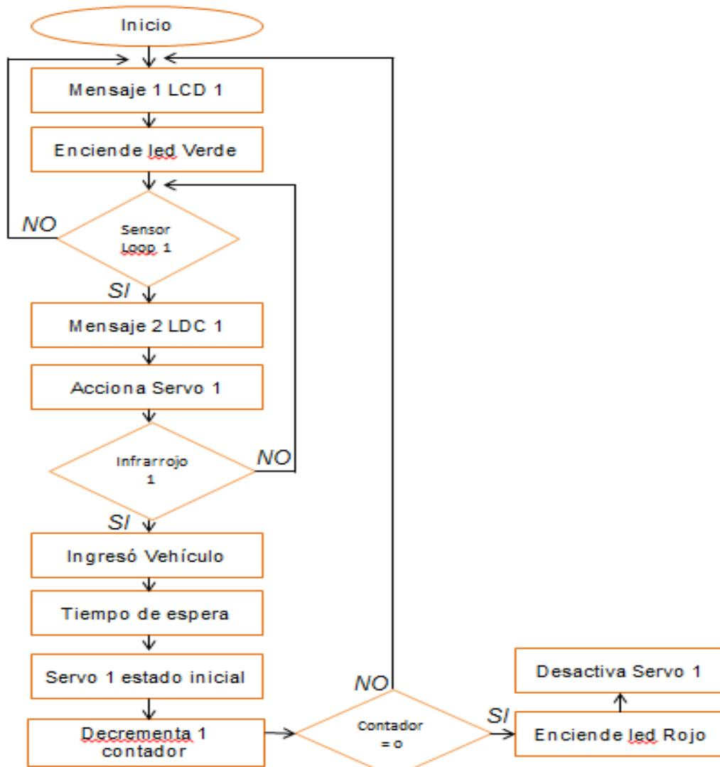
Figura 23. Diagrama de bloques sección 2 “Salida”
