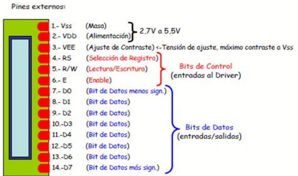
Figura 5. Interface de hardware de la pantalla LCD y el microcontrolador.
