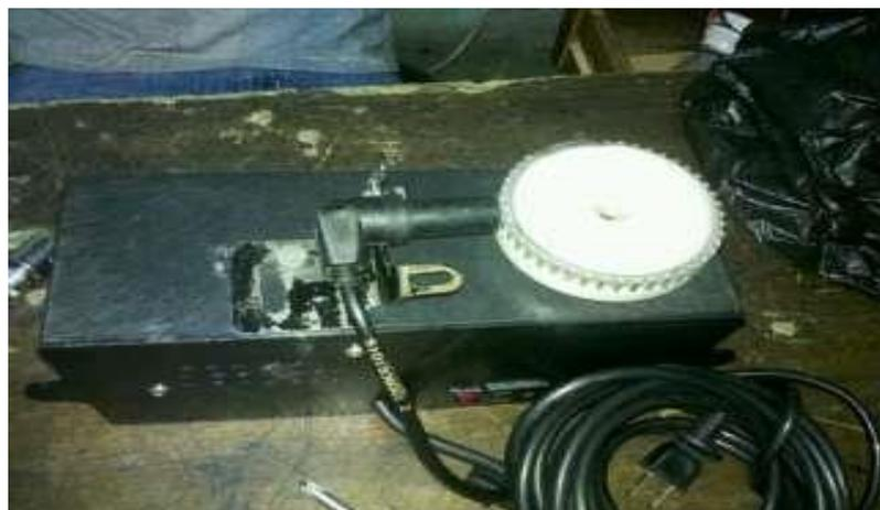
Figura 32. Proyecto físico del simulador de fallas de banco de pruebas de sensor ckp
