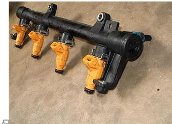
Figura 8. Inyección electrónica
