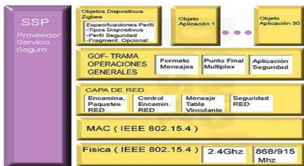
Figura 3. Diagrama de bloques Módulo zigbee
