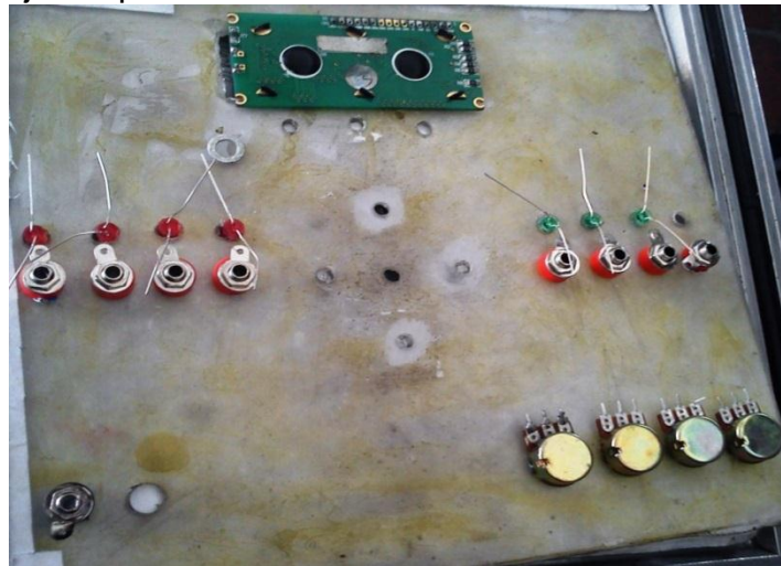
Figura 8. Instalación de diodos led, tomas de voltaje potenciómetros y display en la caratula del chequeador
