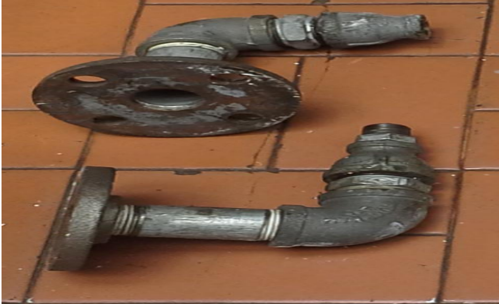
Figura 33. Codos y uniones
