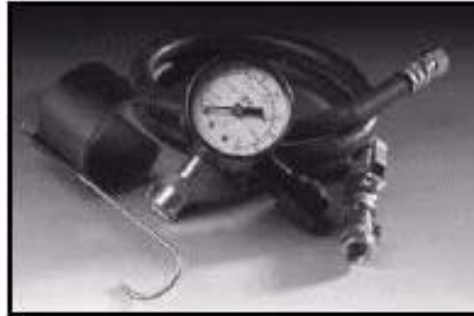
Figura 16. Acople para ingresar líquido limpiador al sistema.
