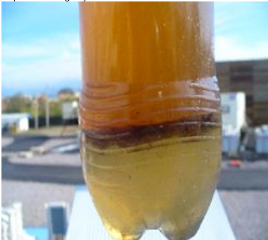
Figura 1. Depósitos de agua y residuos sólidos en el combustible
