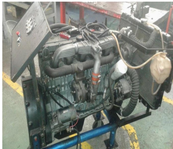
Figura 17. Sistema de refrigeración
