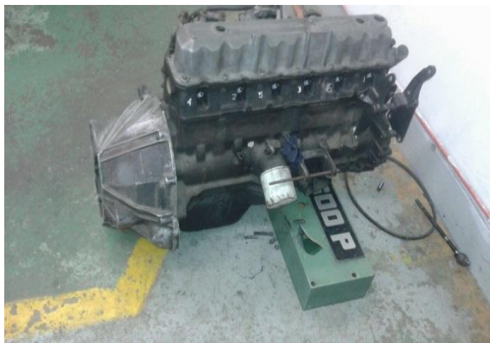
Figura 4. Motor montado sobre el bastidor
