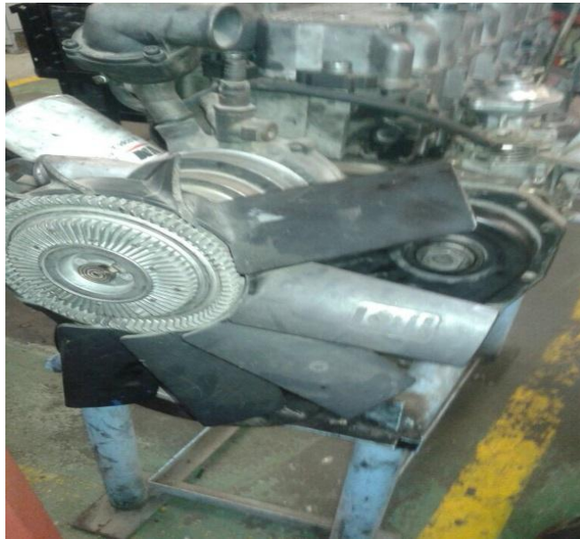
Figura 7. Ventilador reventado Fuente. Foto tomada por Ronald Alexis López
