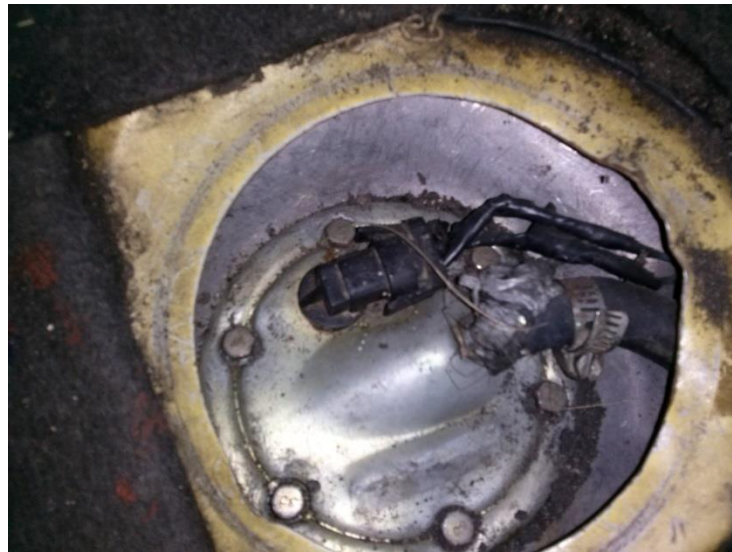
FIGURA 25: BOMBA DE GASOLINA
