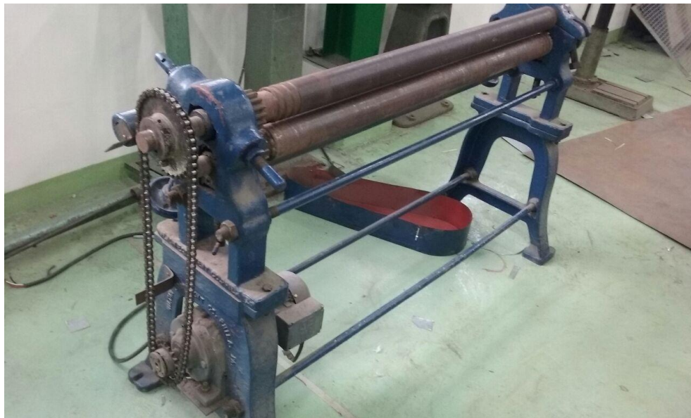
Figura 25. Roladora antes de su reparación
