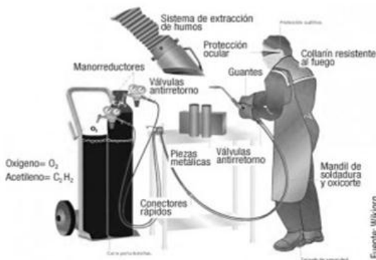
Figura 10. Proceso de soldadura oxiacetilénica
