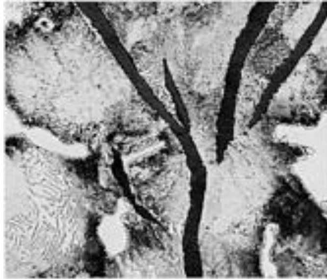
Figura 22. Fundición gris clase 30 (Fe - 3.54C - 2.17Si), austenizado a 870°C (1600°F). Tipo de grafito martensita (oscuro), algunas partículas de carburo de silicio (luz, se indica), y austenita retenida (blanco). 2% Nital. 500 X.
