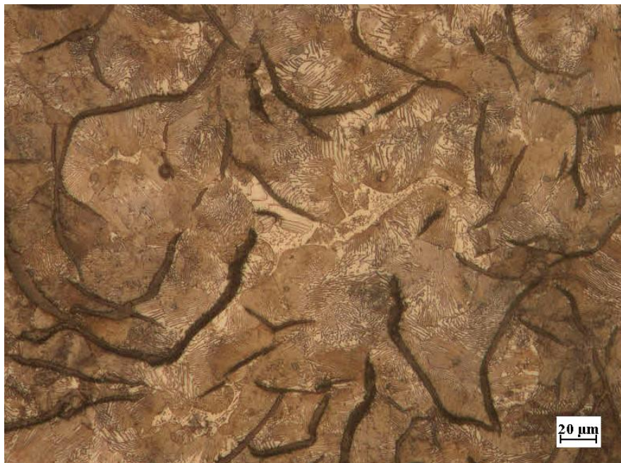
Figura 70. Fundición gris perlítica, grafito tipo A.
