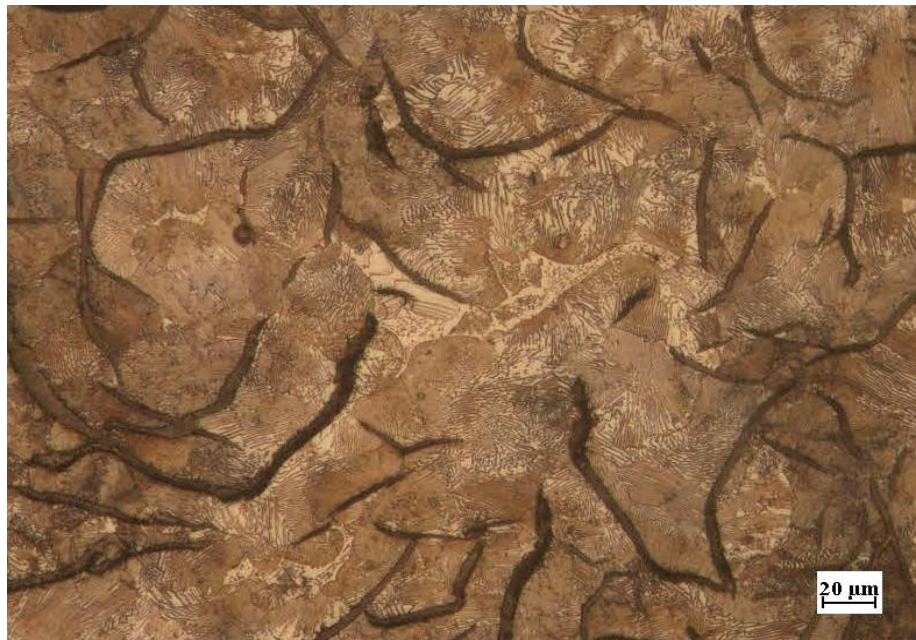
Figura 70. Fundición gris matriz perlítica, grafito tipo A. Nital 2%. 20X.
