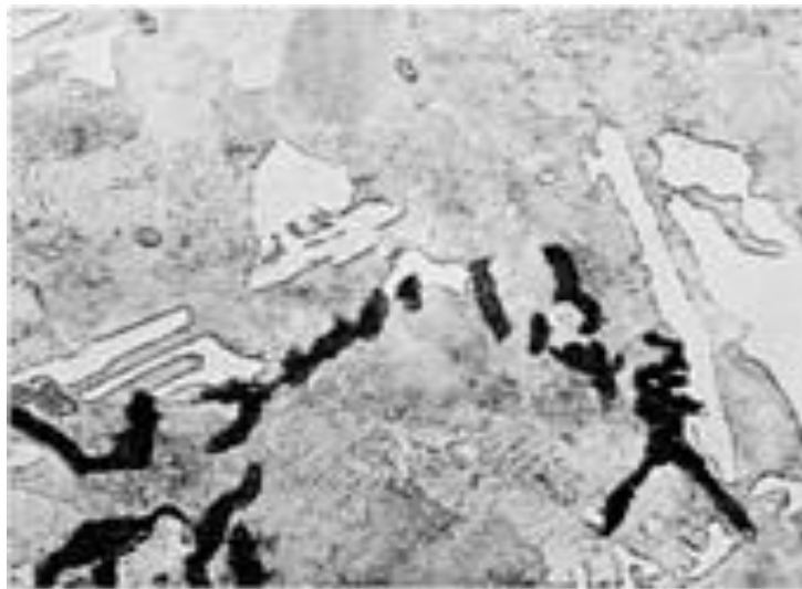
Figura 18. Fundición gris clase 50. La matriz es perlita fina con algunos carburo libre (blanco) que puede haber resultado de solidificación rápida. 2% Nital. 750 X.
