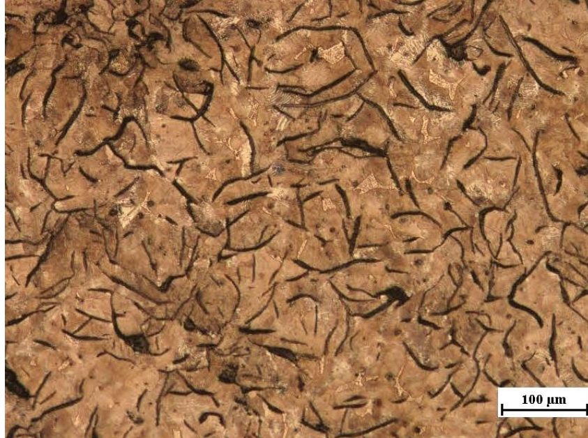
Figura 77. Fundición gris matriz perlítica, grafito tipo A con presencia de esteadita. Nital 2%. 20X.
