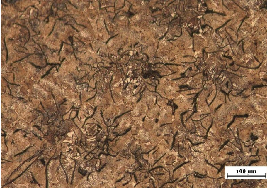
Figura 67. Fundición gris, grafito tipo C, tamaño 4. Sin ataque 10X.
