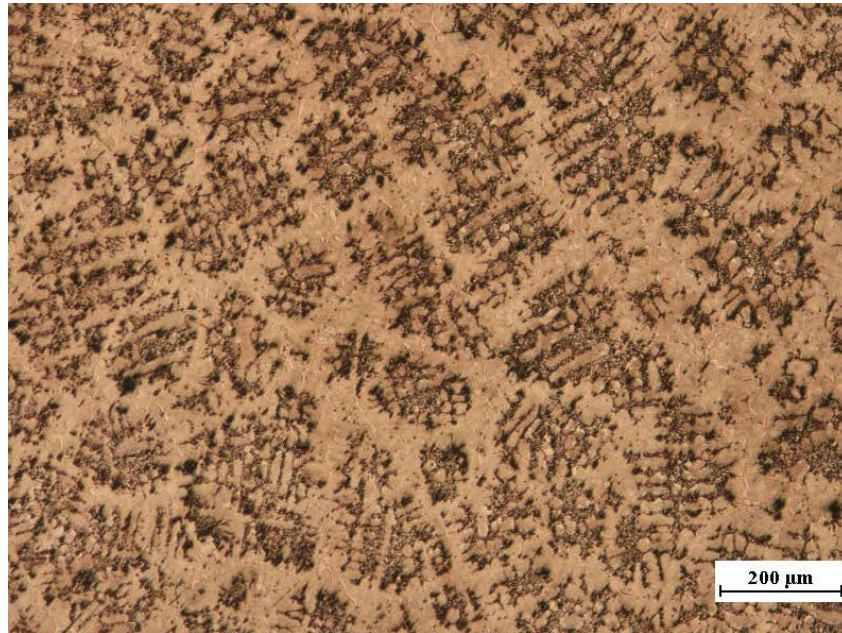
Figura 71. Fundición gris perlítica, grafito tipo B.
