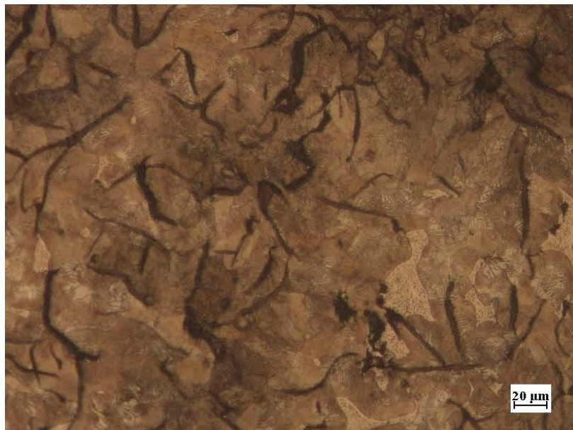
Figura 79. Fundición gris matriz perlítica, grafito tipo A con presencia de esteadita. Nital 2%. 20X.
