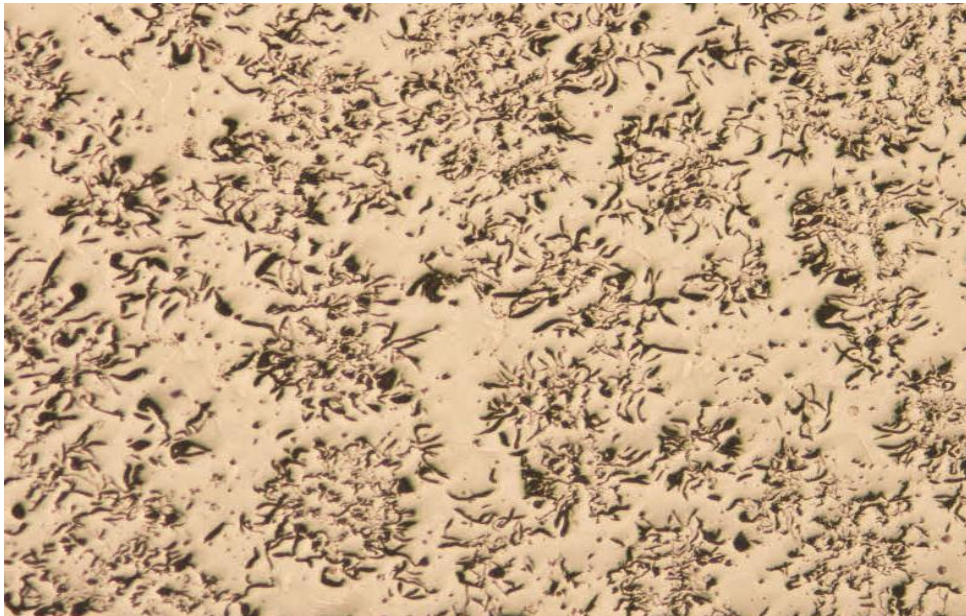
Figura 53. Fundición gris, grafito tipo A sin ataque. 5X.
