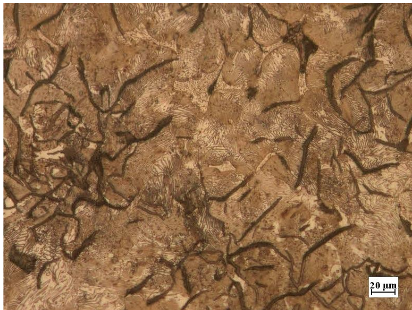
Figura 69. Fundición gris perlítica, grafito tipo B con presencia de esteadita. Nital 2%. 20X.
