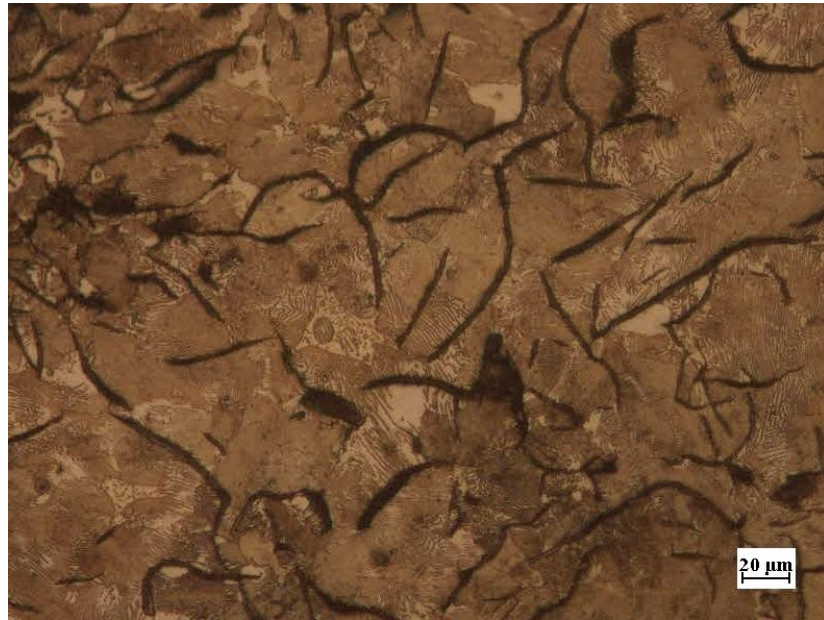
Figura 77. Fundición gris matriz perlítica, grafito tipo A.
