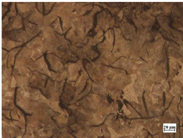
Figura 79. Fundición gris matriz perlítica con presencia de esteadita. Nital 2%. 20X.
