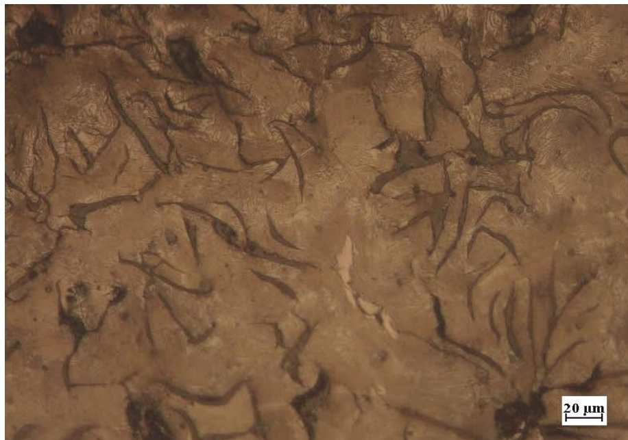
Figura 59. Fundición gris, matriz perlita. Nital 2% 20X.
