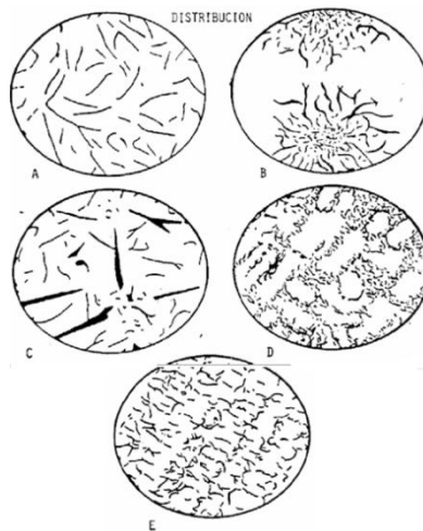
Figura 4. Tamaño y forma (tipo), del grafito laminar presente en la fundición gris.
