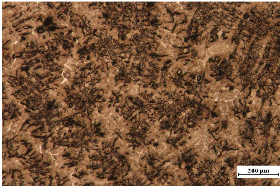
Figura 51. Fundición gris, matriz perlítica, grafito tipo B, con carburos dispersos. Nital 2%. 5X.
