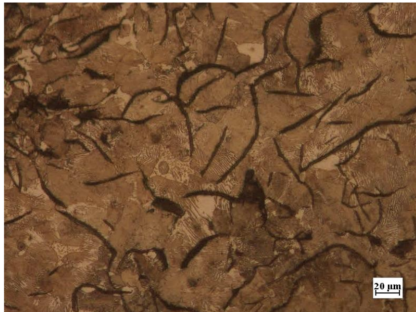
Figura 77. Fundición gris matriz perlítica, grafito tipo A con presencia de esteadita. Nital 2%. 20X.
