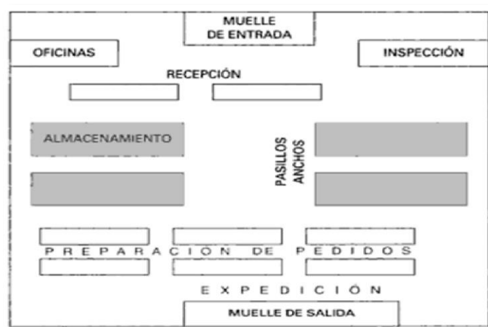
Figura 14 Diseño de almacén, de alta rotación
