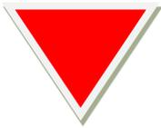
Almacenamiento: Indica deposito de un objeto bajo vigilancia en un almacén donde se recibe o entrega mediante alguna forma de autorización o donde se guarda con fines de referencia.
