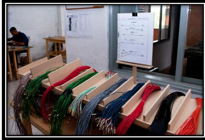
Figura 30. *Mesa con cables empalmados para armar sistema eléctrico.*
