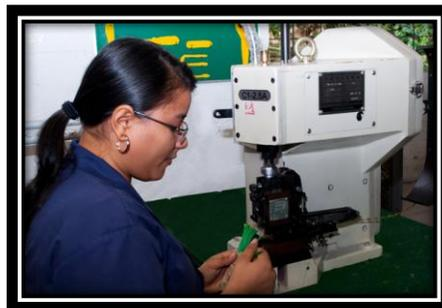
*Figura 29. Máquina Ponchadora Eléctrica. 2012*
