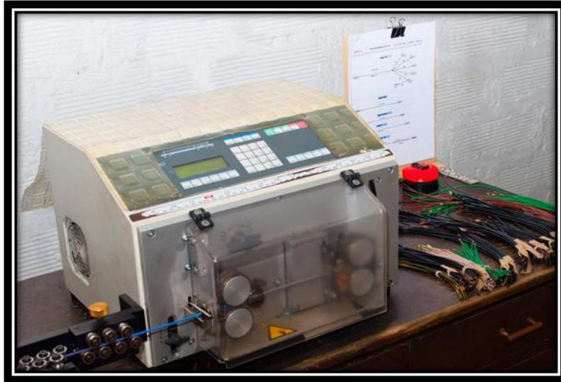
*Figura 28. Máquina Cortadora. 2012 / Elaborado Alvaro Restrepo*
