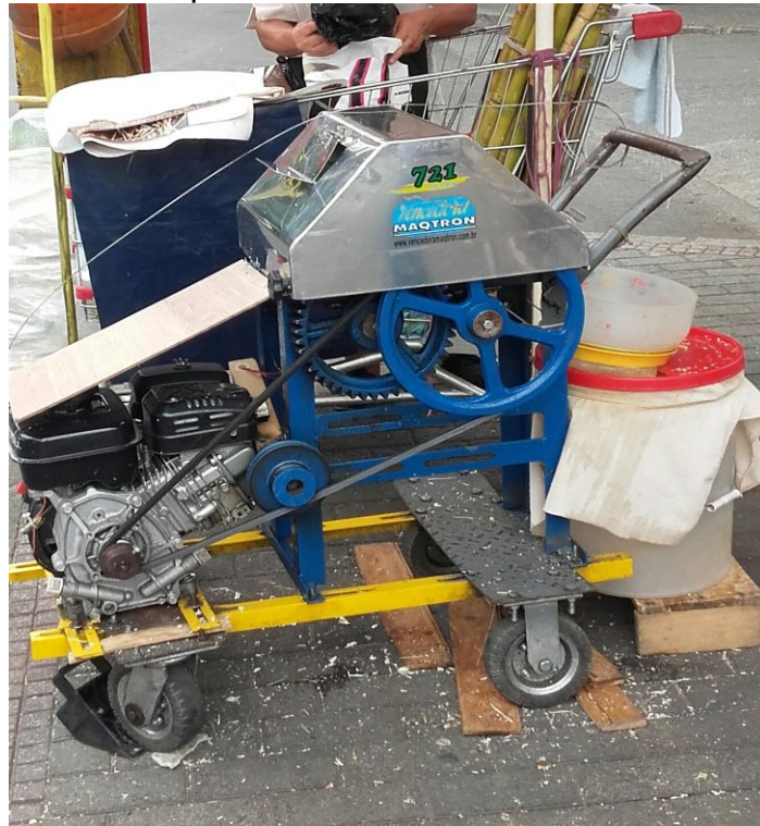
Imagen 5. Trapiche hecho con piezas metálicas
