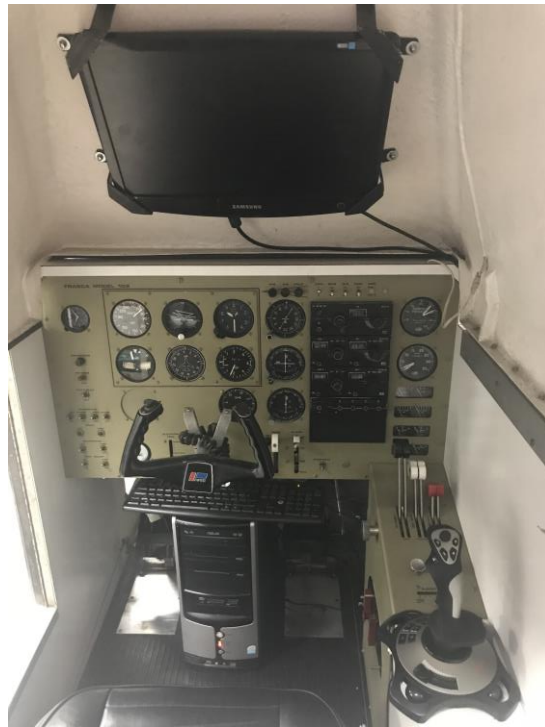
Simulador FRASCA con los equipos de actualización instalados
