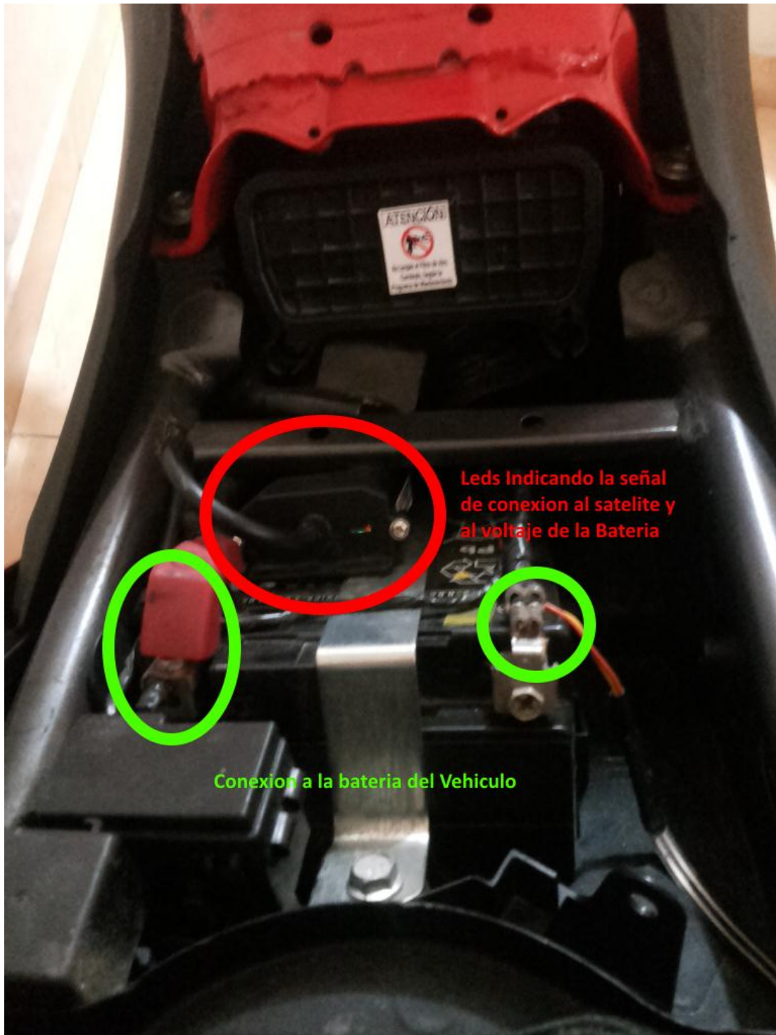
Figura 13. Indicador de señal y voltaje de la unidad
