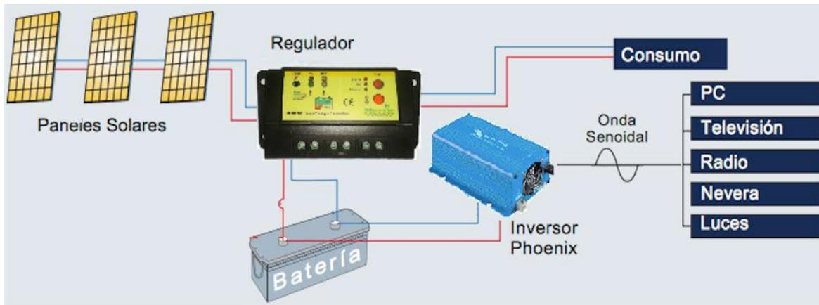
Figura 15. Esquema de conexión al inversor
