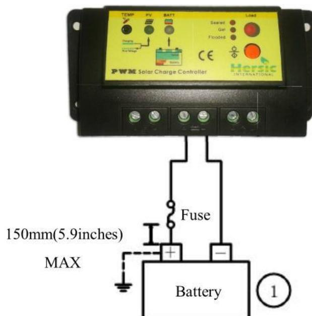
*Figura 11. Conexión de las baterías al controlador de carga*
