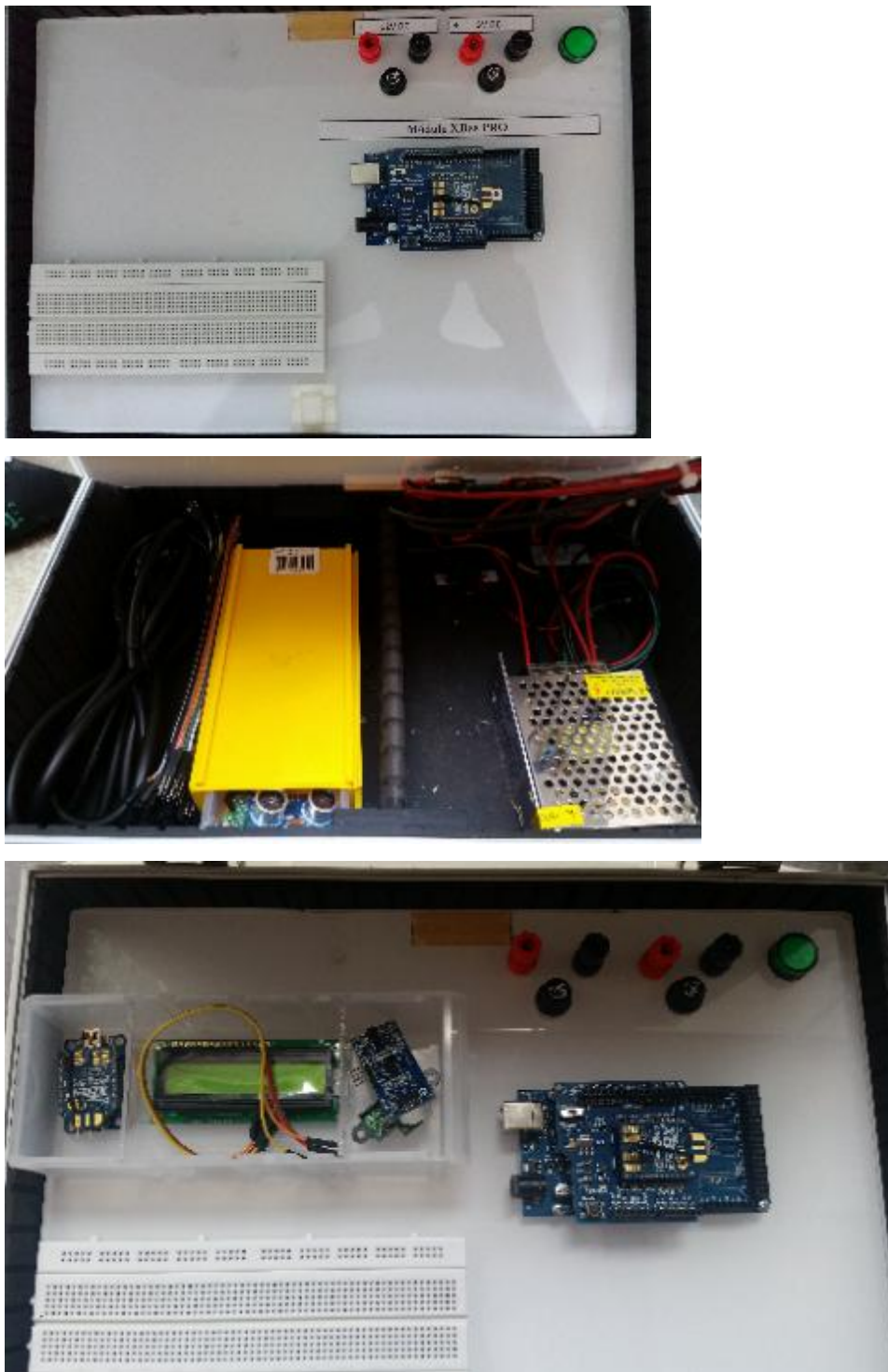
Figura 24: Modulo Didáctico XBee. Fuente: Propia Alumnos.
