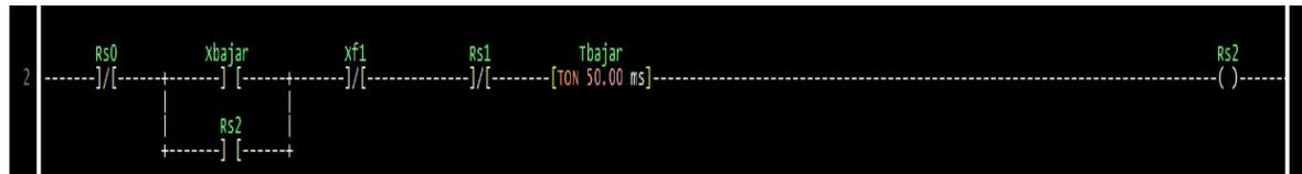
**Rs0** contacto relé interno inversamente proporcional a señal de parada.
