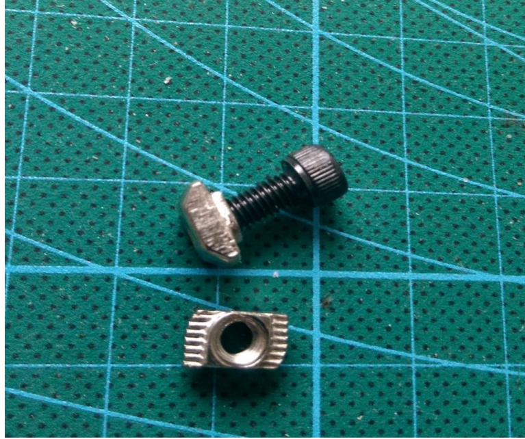
Figura 20 Tornillos de ensambles con su respectiva tuerca Fuente: Foto tomada por el autor
