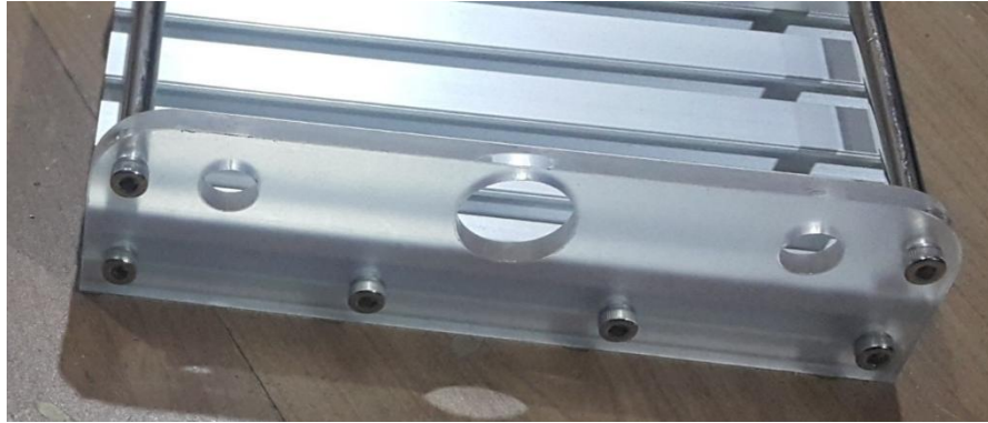
Figura 37 Ensamble del eje de rodamiento a la cama de fresado Fuente: Foto tomada por el autor
