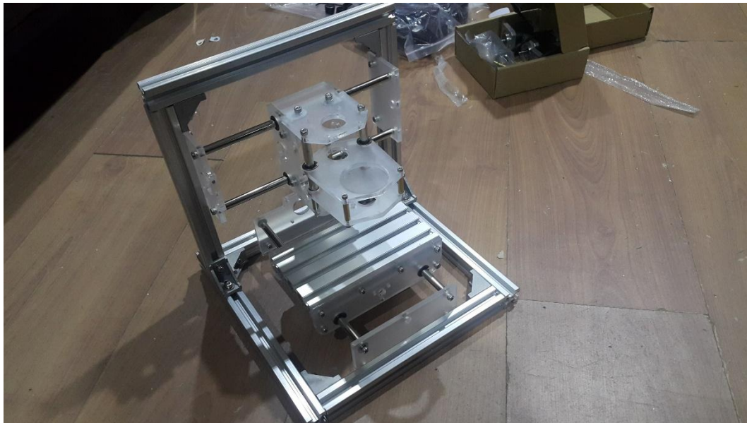
Figura 40 Ensamble completo de la estructura CNC Fuente: Foto tomada por el autor
