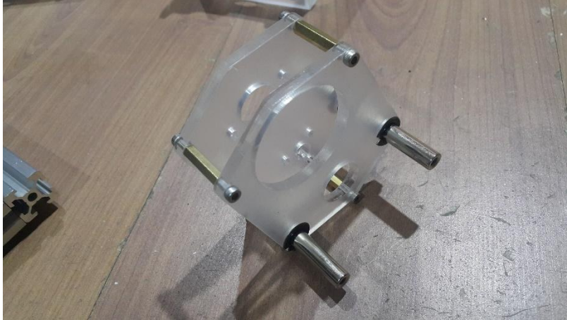
Figura 28 Ensamble completo de la estructura del motor de fresado Fuente: Foto tomada por el autor
