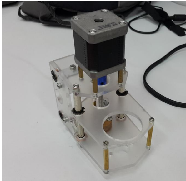
Figura 34 Ensamble de la estructura del eje z a la del eje y Fuente: Foto tomada por el autor
