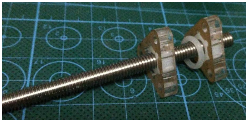
Figura 24 Eje de rodamiento 8mm eje y Fuente: Foto tomada por el autor
