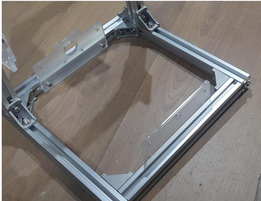
Figura 36 Piezas de laterales para el montaje de la cama de fresado
