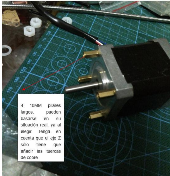
Figura 32 Motor stepper con arandelas largas
