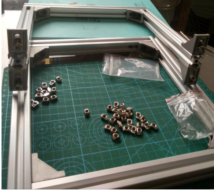
Figura 16 Eje X y Y con su respectivos acoples angulares Fuente: Foto tomada por el autor
