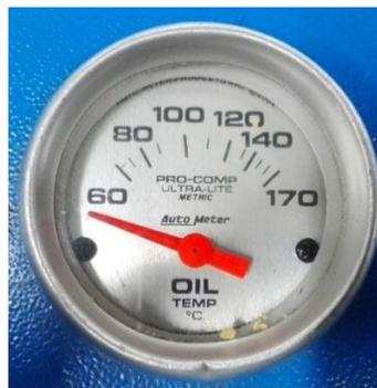
*Imagen 5.* Medidor de temperatura de aceite.
