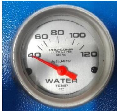
*Imagen 4.* Medidor de temperatura del líquido refrigerante.
