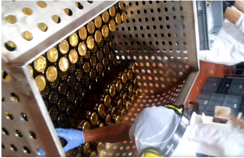
Imagen 14. Ubicación de unidades para el proceso de autoclave.
