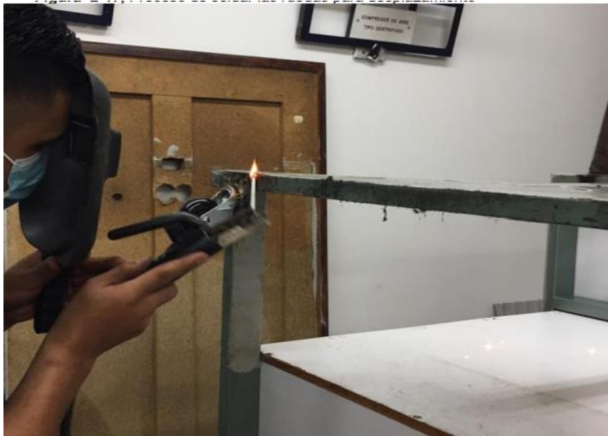
Imagen 4.4 Proceso de soldadura de ruedas en la estructura.
