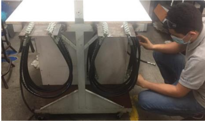
Imagen 5.6. Prueba de montaje de soporte para acoples de las mangueras.
