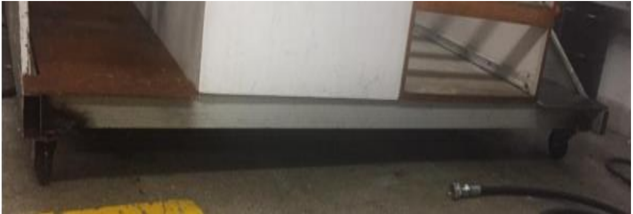
Imagen 5.8 Ruedas instaladas para desplazamientos del módulo.
