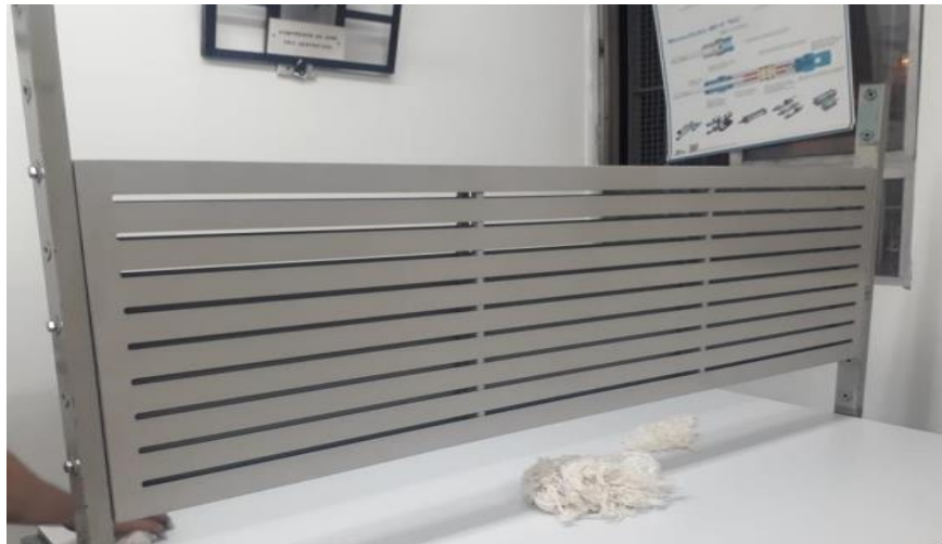
Imagen 5.5 Panel de ensamble instalado al chasis.
