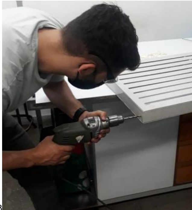
Imagen 5.3 Perforación a panel de ensamble.
