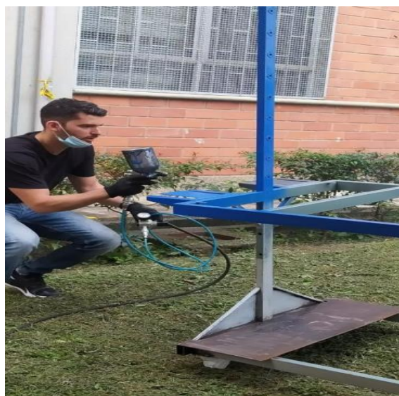
Imagen 4.6 Proceso de aplicación de pintura electrostática.
