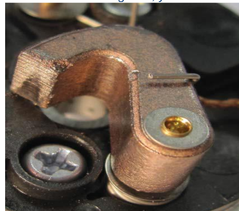
¡Error! No se encuentra el origen de la referencia. Ilustración 2- Escobilla de 50% grafito, y 50% cobre
