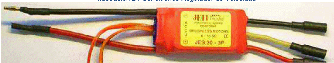
Ilustración 21 Conexiones Regulador de Velocidad
