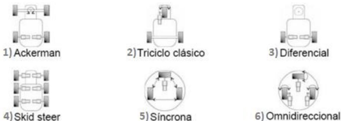
Figura 3. Configuración de ruedas en los robots móviles
