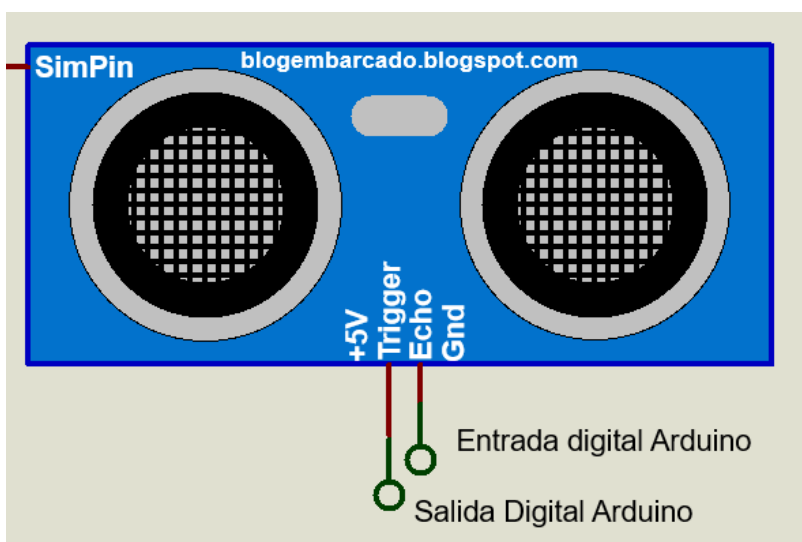
Figura 28. Estructura de los sensores de ultrasonido
