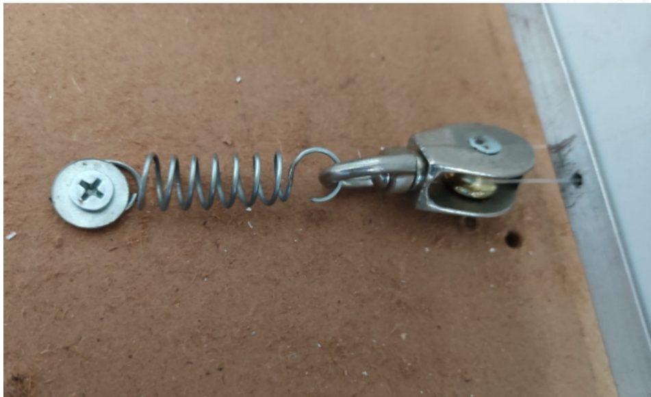
Ilustración 16. Resorte tensor con polea
