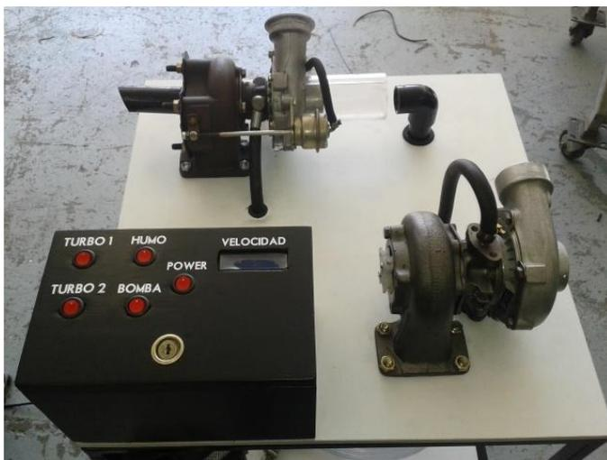
Imagen 7. Turbo compresores y caja de control
