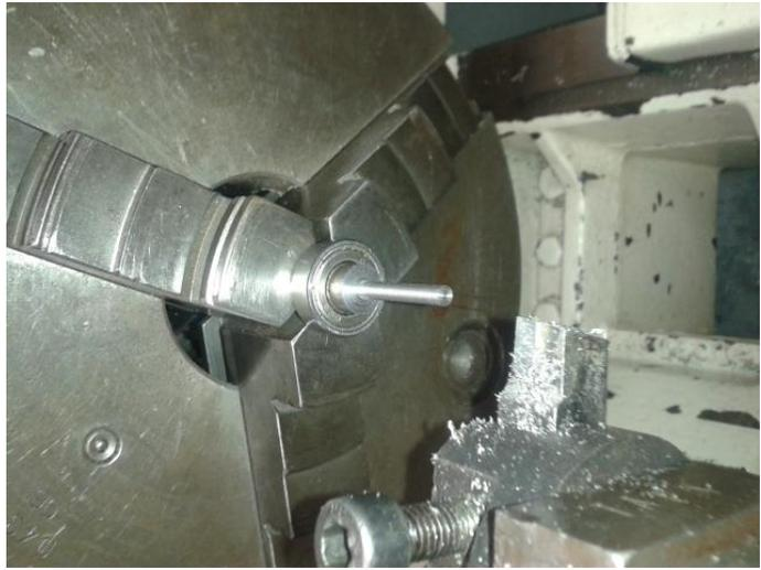
Imagen 3. Imagen 4. Mecanizado del eje para la sopladora
