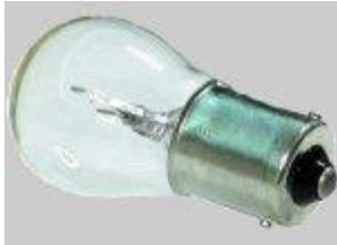
Figura 5. Bombillo de un filamento.
