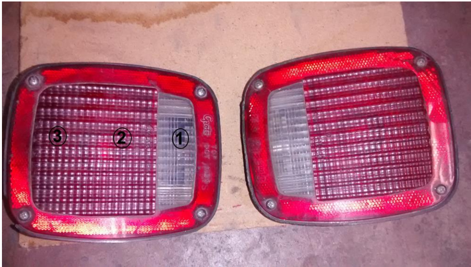
Figura 28. Farolas traseras stop, luces media y reversa.
