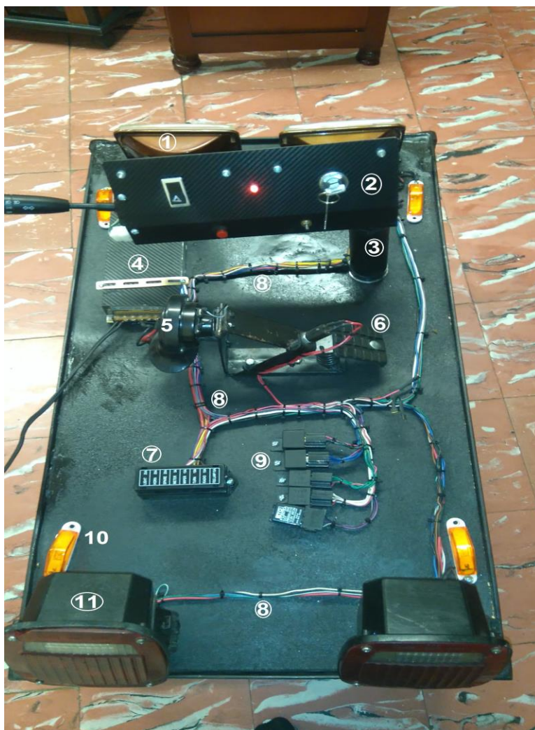
Figura 45. Componentes del sistema de luces de un vehículo.
