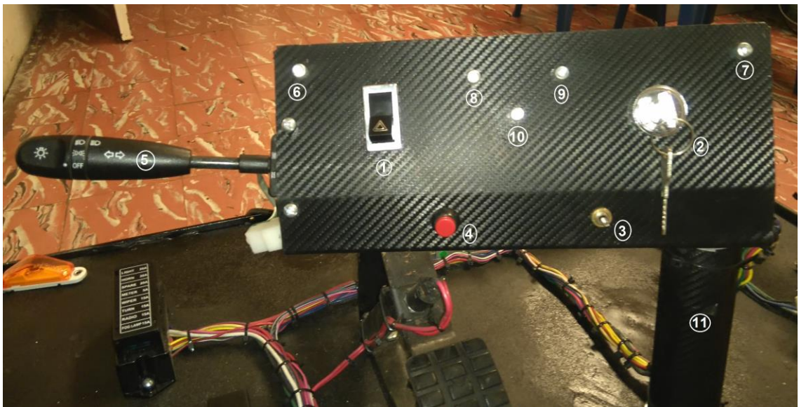
Figura 37. Tablero de interruptores e indicadores led.
