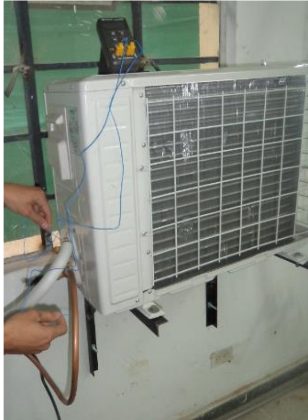
Figura 26. Practica operación 25 Termómetro digital 52228, lectura temperatura, laboratorio de refrigeración IUPB
