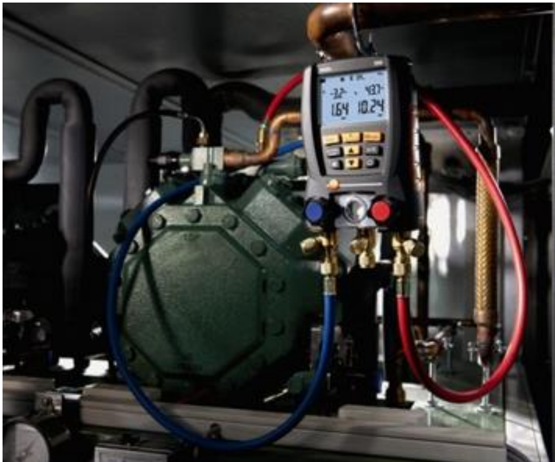
Figura 21. Disposición de mangueras equipo testo 550
