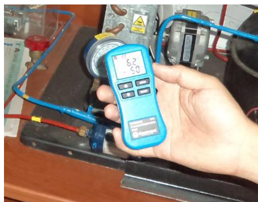
Figura 23. Practica operación carta digital presión/temperatura 52245, lectura equipo presión y temperatura, laboratorio de refrigeración IUPB
