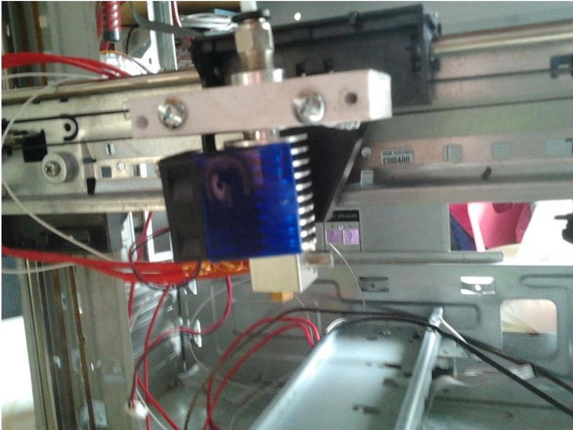
Figura 21. Extrusor acoplado al eje X Fuente: diseño del realizador proyecto de grado
