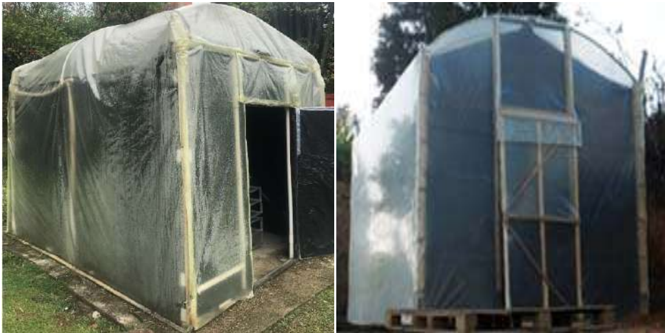
Figura 4. Secador de doble pared y con cámara de precalentamiento de aire
