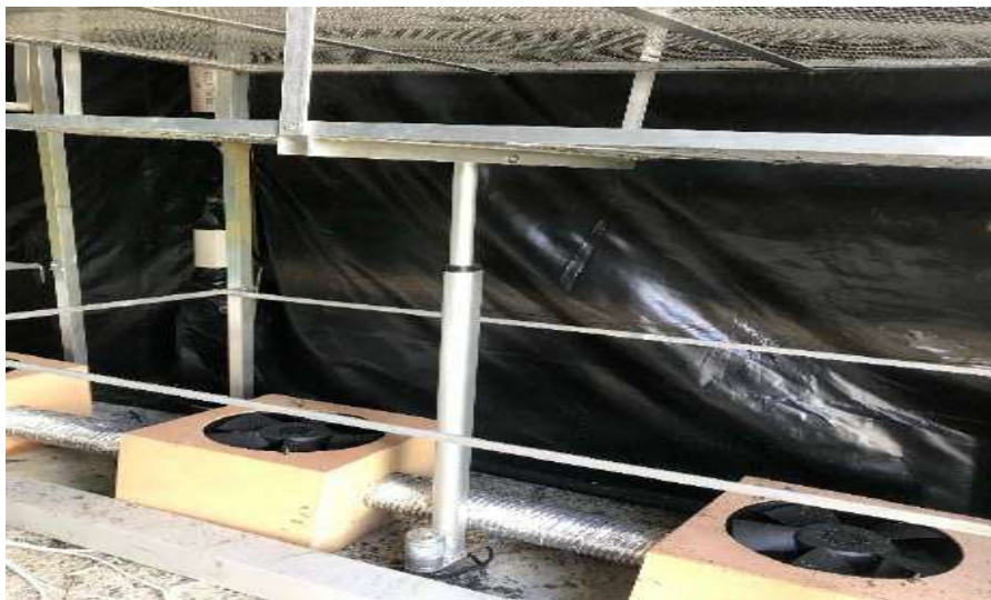
Figura 5. Sistema de posicionamiento vertical de camas contenedoras de material vegetal
