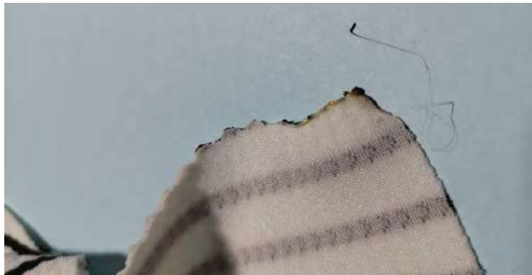
Figura 4. Muestra de cenizas para fibras sintéticas en análisis pirométrico.
