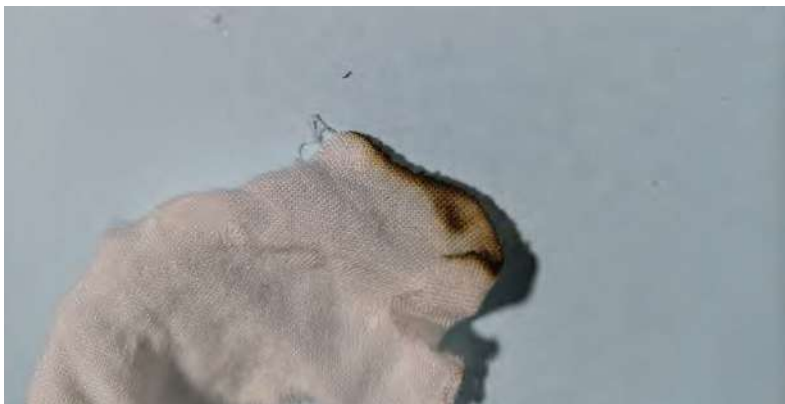
Figura 5. Muestra de cenizas para fibras naturales en análisis pirognóstico.
