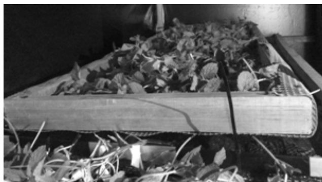
Figura 11. Bandeja para pesaje instalada
